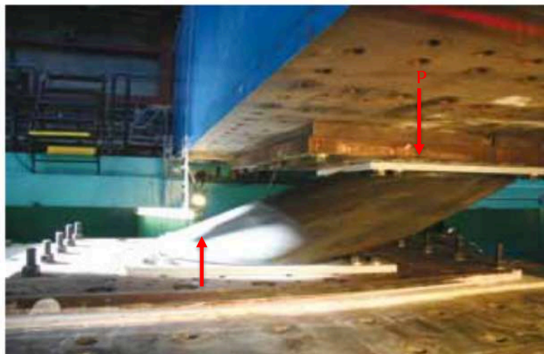
Figura N° 5 Ensayo de Aislador Prueba extrema 400% Fuente: Universidad Central de Ecuador
