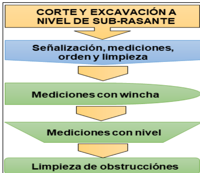
Figura 26:Diagrama de actividades para la partida corte y excavación a nivel de sub-rasante Fuente: Elaborado por los autores
