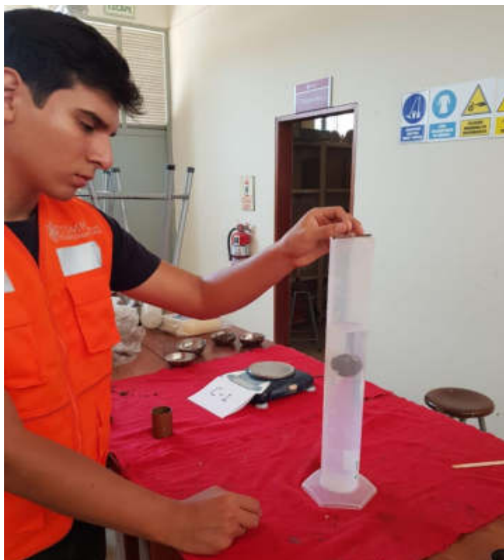
FOTOGRAFÍA N° 43: Al desplazar el agua, se toma un nuevo volumen, el cual vendría a ser el volumen final.
