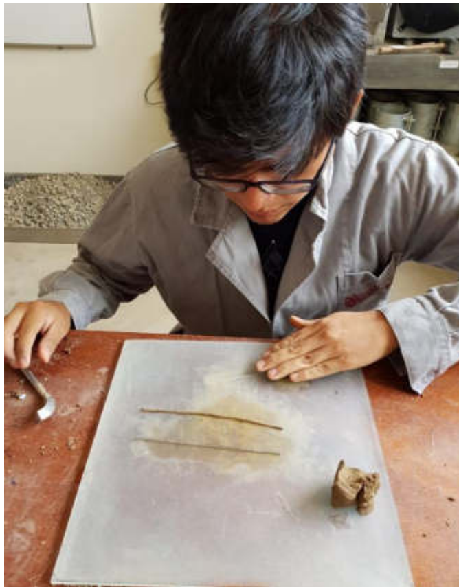
FOTOGRAFÍA N° 20: De la muestra empleada en límite líquido, se utilizó 20g para realizar el ensayo de límite plástico, enrollando la muestra en un vidrio esmerilado, hasta que alcance el diámetro de la varilla de 3.2 mm, se coloca en una tara, se pesa y se lleva al horno por 24 horas. Cumplido el tiempo se saca y se vuelve a pesar.
