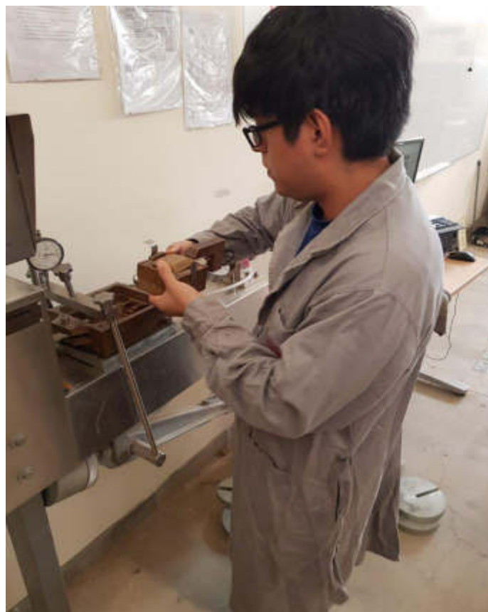
FOTOGRAFÍA N° 60: Concluido el ensayo, se procedió a sacar la caja de corte directo.
