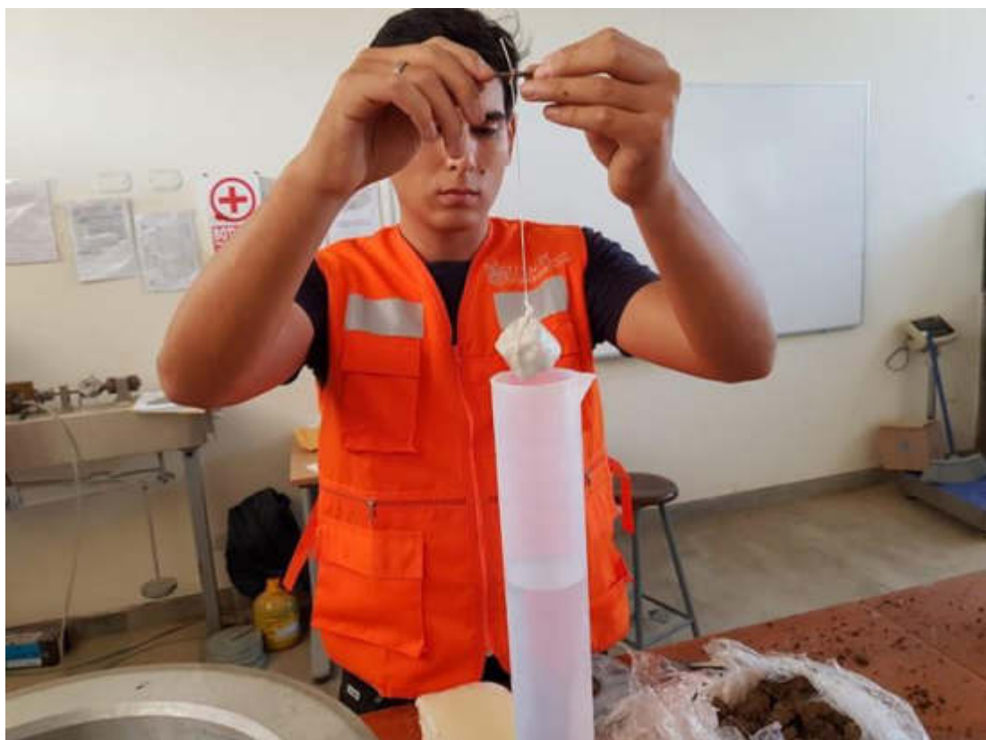
FOTOGRAFÍA N° 42: Se colocó en una probeta graduada la muestra, anotando previamente el volumen inicial que este tiene.
