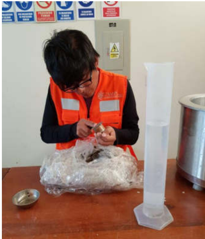
FOTOGRAFÍA N° 39: Se talló la muestra inalterada con el molde destinado para realizar el ensayo.
