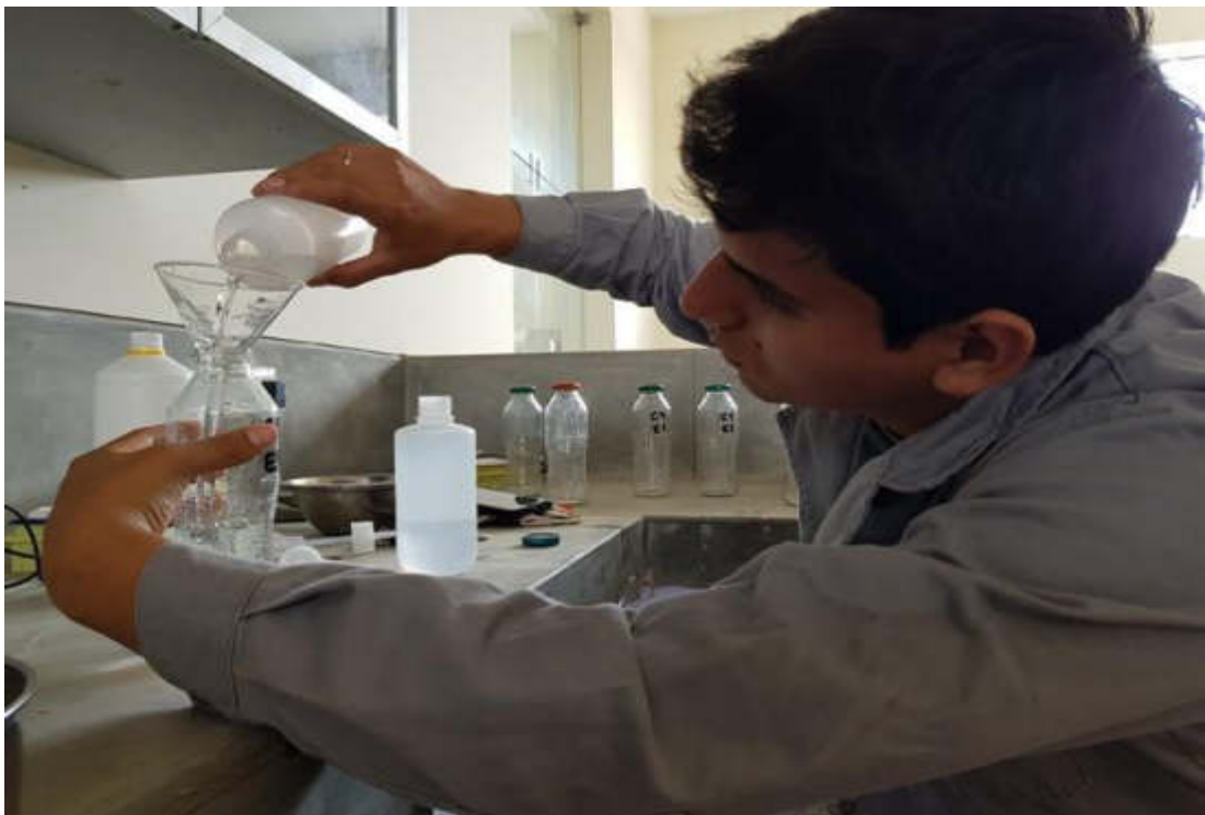
FOTOGRAFÍA N° 24: La relación que se tuvo fue de 1:3, se vertió en la botella 300 ml de agua destilada.
