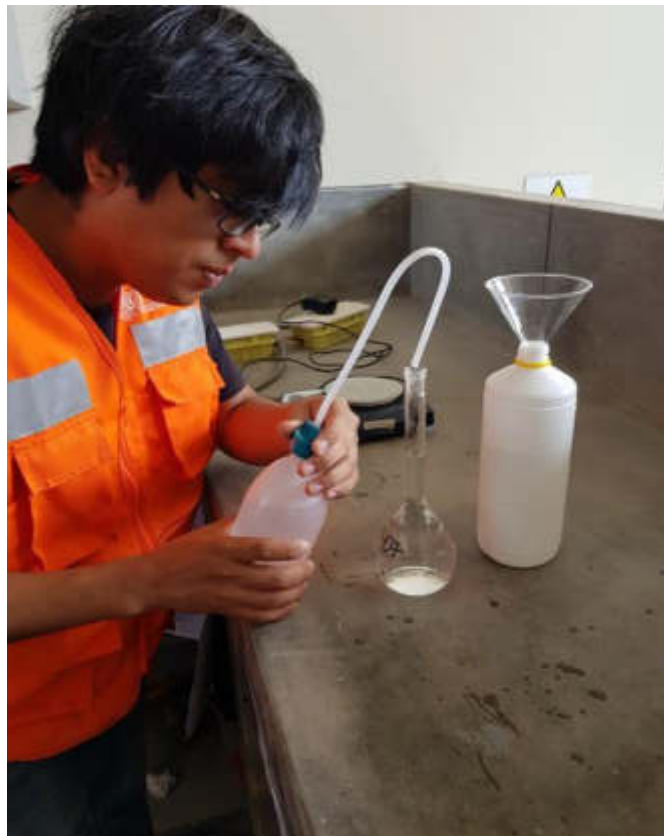
FOTOGRAFÍA N° 30: Se llenó con agua destilada cada fiola con 3/4 de su contenido, con ayuda de una piseta.
