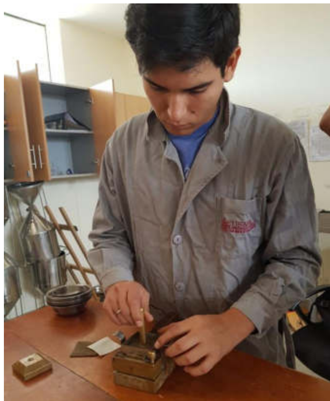
FOTOGRAFÍA N° 54: Con ayuda de un extractor de muestra se coloca la muestra en la caja de corte directo.
