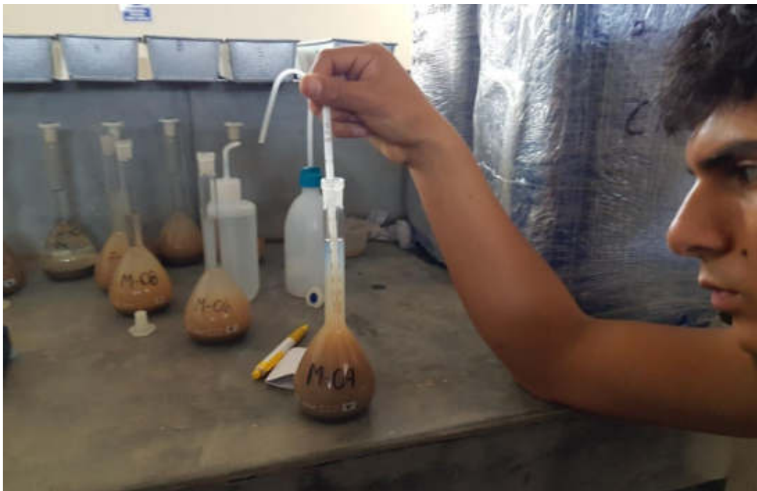
FOTOGRAFÍA N° 37: Con ayuda de un termómetro, se mide la temperatura. Teniendo siempre en cuenta que se midió a una misma altura.
