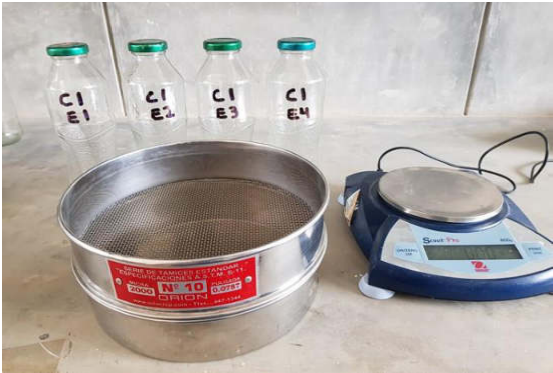
FOTOGRAFÍA N° 21: Para el ensayo de contenido de sales, se necesitaron botellas de vidrio (debidamente identificadas), papel filtro, balanza, embudo, matraz, beaker y tamiz N°10.
