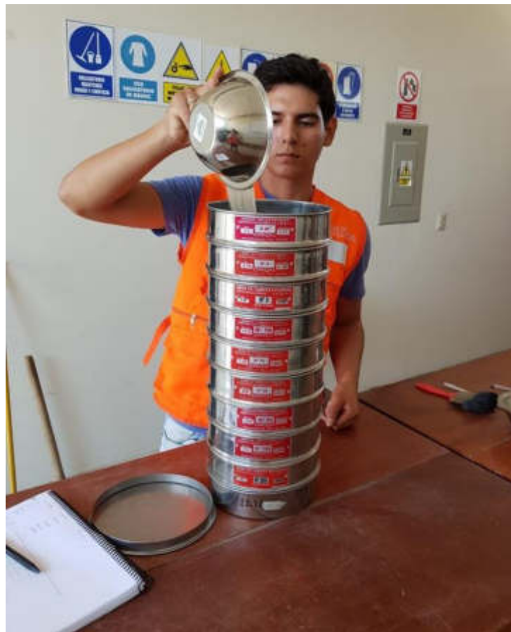
FOTOGRAFÍA N° 12: La muestra previamente lavada, se llevó al horno, pasado 24 horas, se saca. Se ordena los tamices según la NTP 339.128 y se procede a colocar la muestra para realizar el tamizado.
