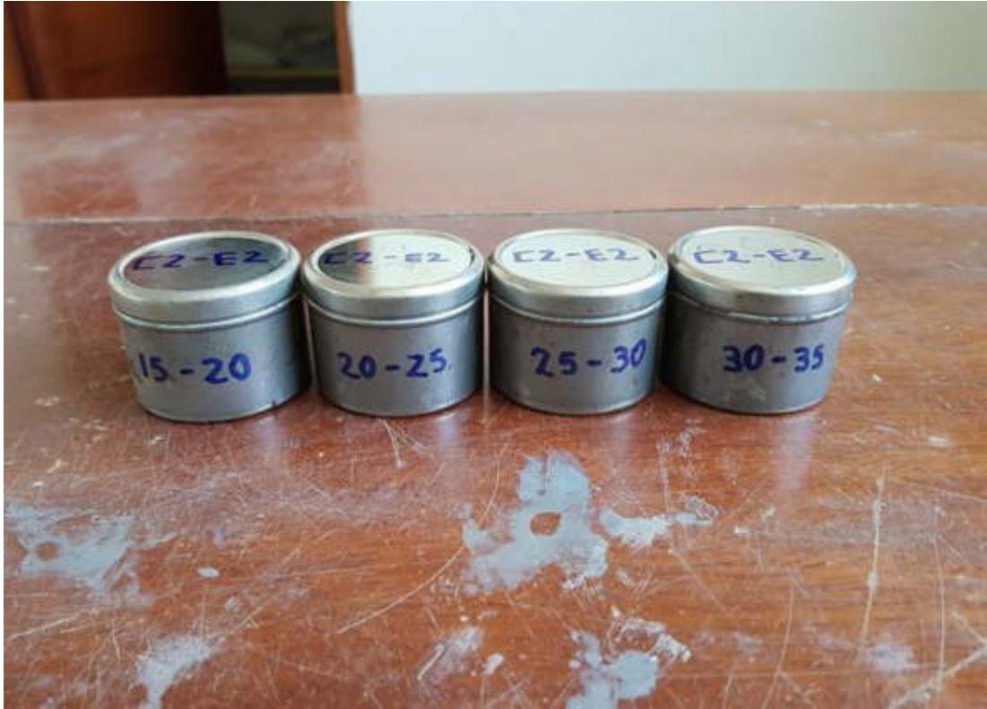
FOTOGRAFÍA N° 17: Pasado 24 horas, se enumeraron las taras pequeñas, cada una con el respectivo rango, para el ensayo de límite líquido. Se procedió a sacar la muestra que se dejó envuelta.
