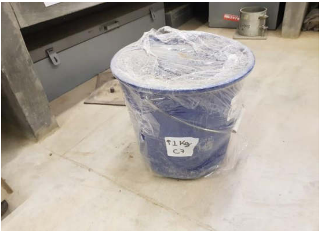
FOTOGRAFÍA N° 50: Se forró con rollo film el balde con el fin de evitar que agentes externos alteren la muestra.
