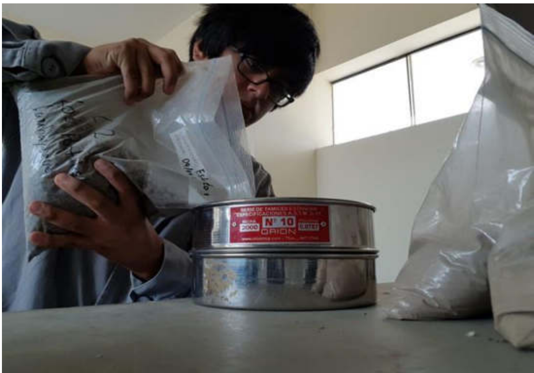
FOTOGRAFÍA N° 22: Se pasó por el tamiz N°10, la muestra a ensayar y se tomó 100g de esta, este proceso se realizó para cada estrato de cada calicata.
