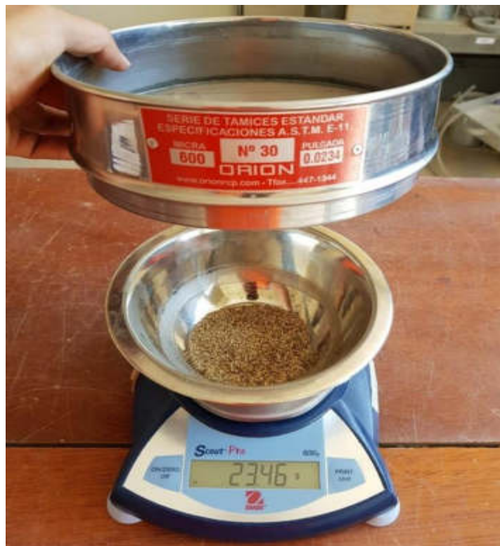
FOTOGRAFÍA N° 14: Se pesa la muestra retenida, esto se realiza para cada tamiz utilizado para el ensayo. Se anotaron estos datos ordenadamente.
