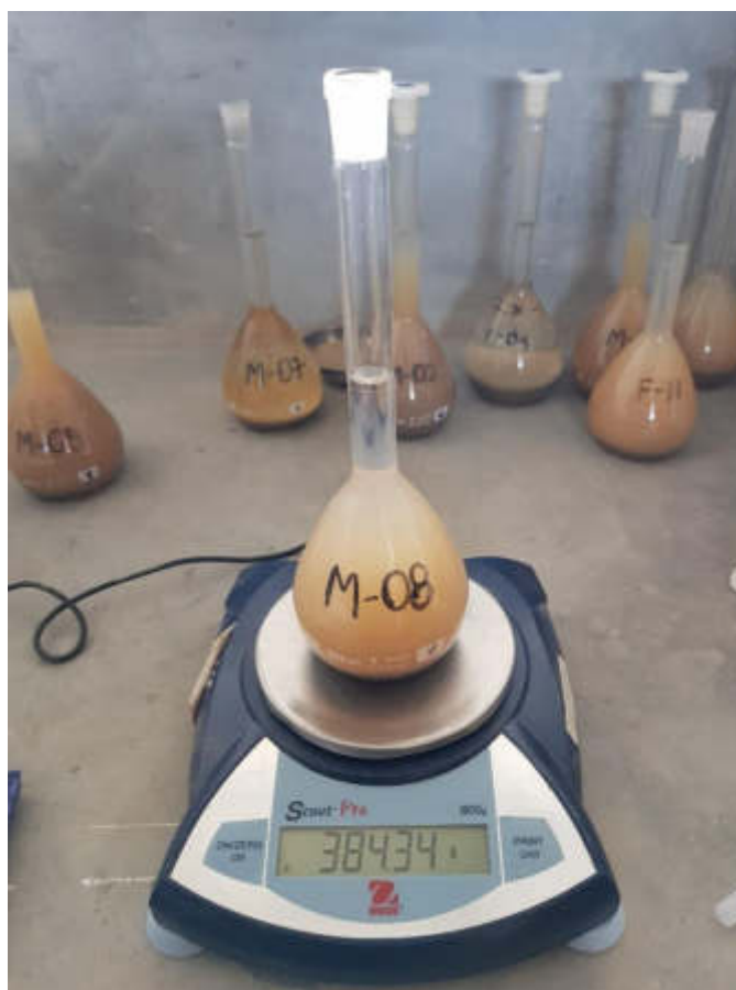
FOTOGRAFÍA N° 38: Se tomó la temperatura de la fiola, se pesó y se enrasó, hasta que se encuentre en una temperatura ambiente.
