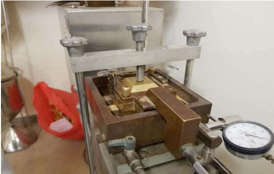
FOTOGRAFÍA N° 57: Se cercioro que tanto caja de corte como dial se encuentran correctamente instalados.
