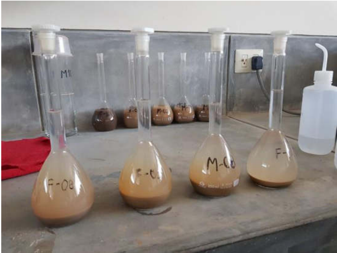
FOTOGRAFÍA N° 35: Se vierte la muestra en las fiolas, junto con el agua destilada, con ayuda de un embudo.
