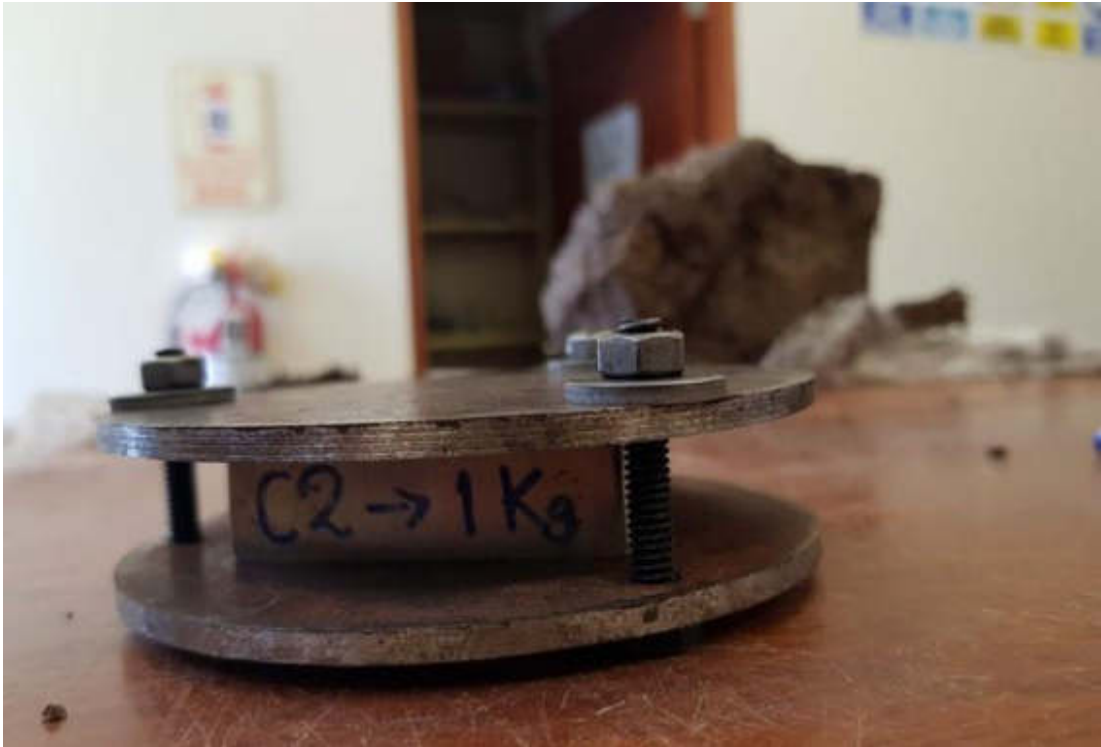
FOTOGRAFÍA N° 47: Se catalogó cada molde cuadrado con los respectivos pesos a los que serían ensayados, para llevar un óptimo control.
