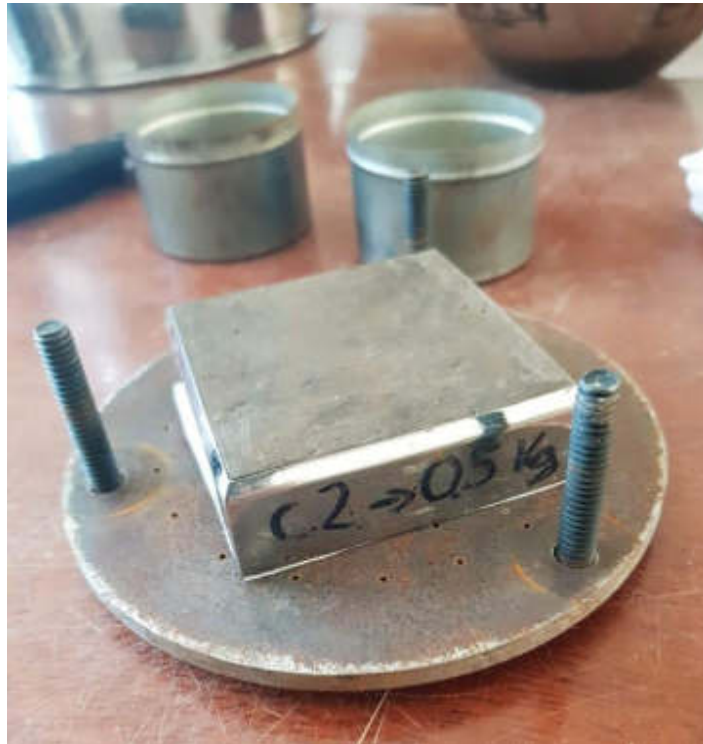
FOTOGRAFÍA N° 45: Se talló con un molde cuadrado la muestra inalterada.
