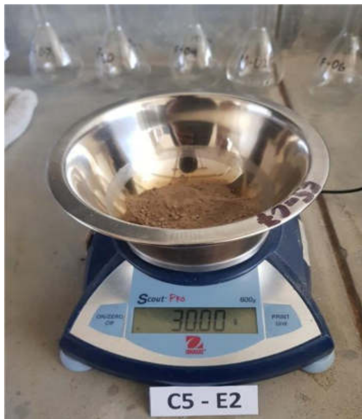
FOTOGRAFÍA N° 34: Se utilizó 30g de muestra representativa que pasa por el tamiz N° 4
