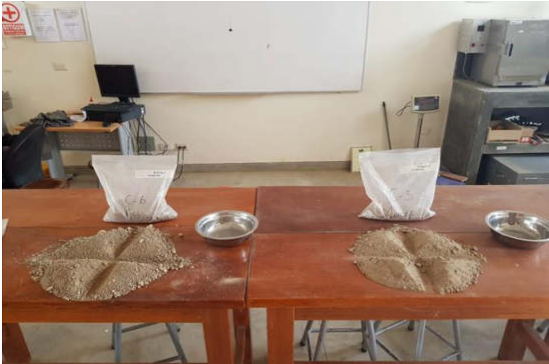
FOTOGRAFÍA N° 09: Se realizó el cuarteo de las muestras con ayuda de una regla metálica, se escogieron dos extremos del cuarteo para el ensayo.
