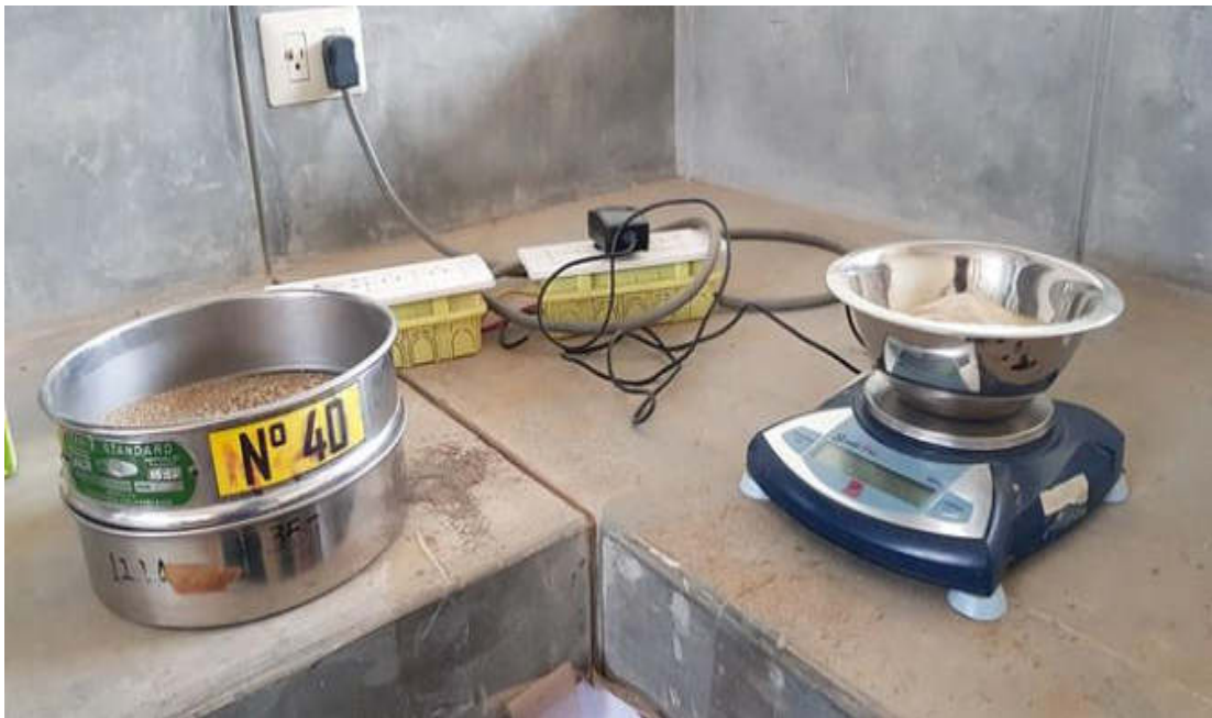
FOTOGRAFÍA N° 15: Se utilizó la malla N°40 para este ensayo, se pesó 200g de muestra que pasó este tamiz.
