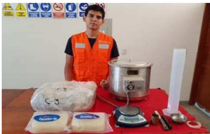
Figura 46. Muestras y materiales para ensayo de peso específico volumétrico. Fuente: Elaborado por los autores.
