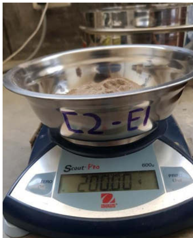
FOTOGRAFÍA N° 16: Se pesan los 200g sin considerar el peso de la tara, se le adiciona agua destilada y se mezcló. Se envolvió con un poco de rollo film y se dejó por 24 horas.
