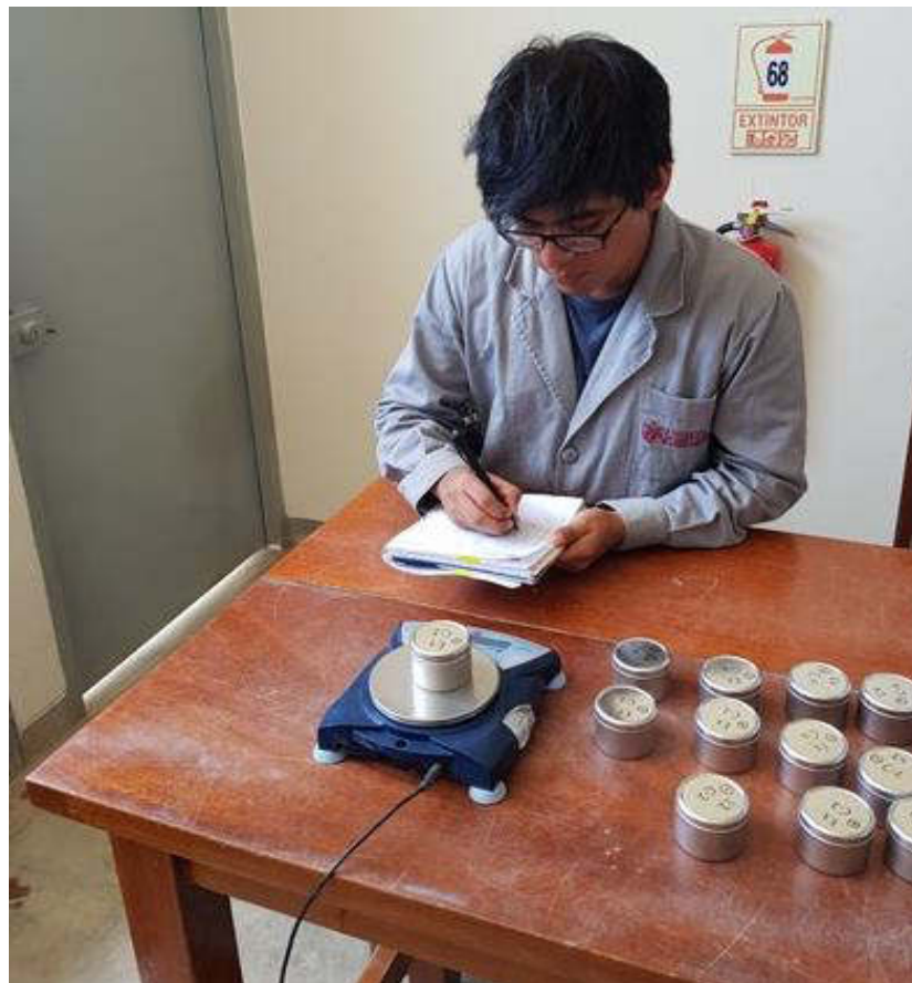
FOTOGRAFÍA N° 02: Se procedió a pesar cada tara en la balanza, se anotaron en una libreta los pesos de la tara sola y la tara con muestra de cada calicata.
