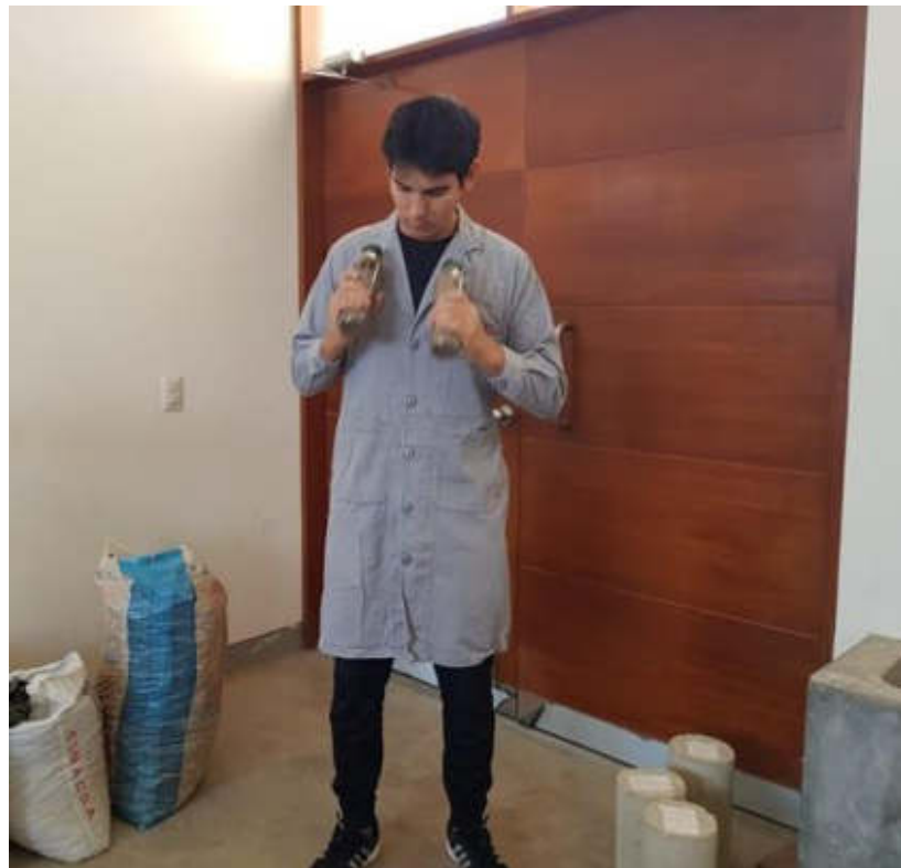
FOTOGRAFÍA N° 26: Se agitan las muestras por un periodo de 1 hora, de manera homogénea, con un movimiento continuo.
