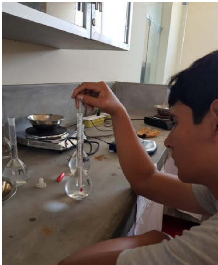
FOTOGRAFÍA N° 32: Una vez producida la ebullición, se sacaron de la cocina y se tomó la temperatura. Se enrasó hasta que esta llega a una temperatura ambiente.
