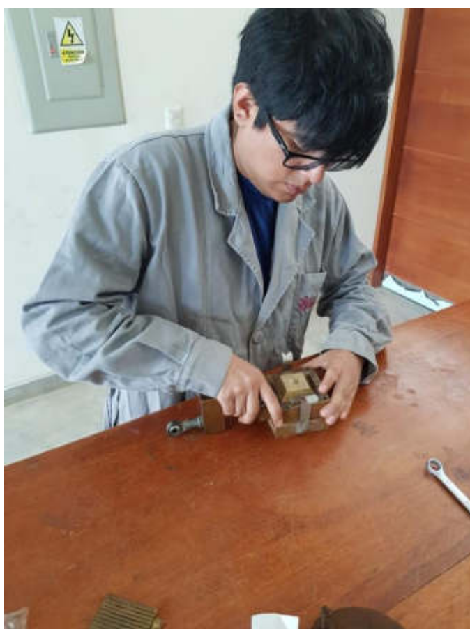
FOTOGRAFÍA N° 61: Con sumo cuidado se desensambla la caja de corte directo.
