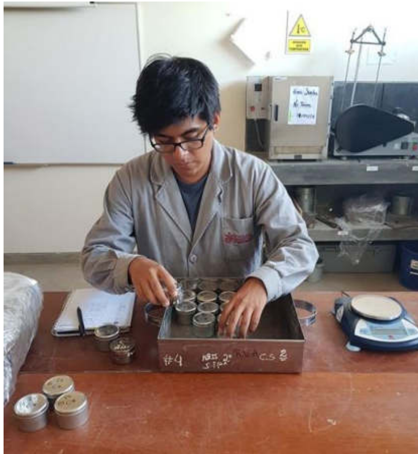
FOTOGRAFÍA N° 03: Una vez pesada todas las taras, se colocaron en una bandeja y fueron llevadas al horno por un tiempo de 24 horas.
