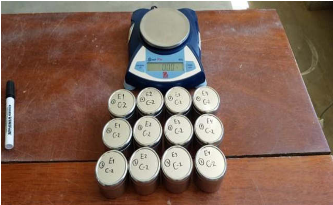
FOTOGRAFÍA N° 01: Taras clasificadas con numeración para realizar el ensayo y llevar un mejor control, para de esta manera llegar a los resultados correctos.
