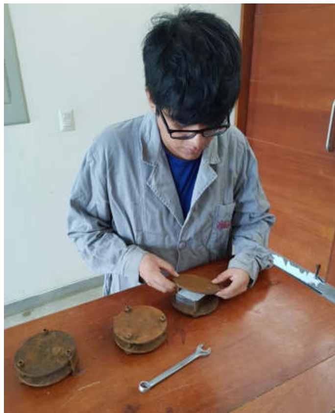
FOTOGRAFÍA N° 46: Se colocó las bridas una arriba y la otra abajo del molde cuadrado, colocando previamente sobre y debajo del molde cuadrado papel filtro. Se aseguró con tornillos y tuercas.
