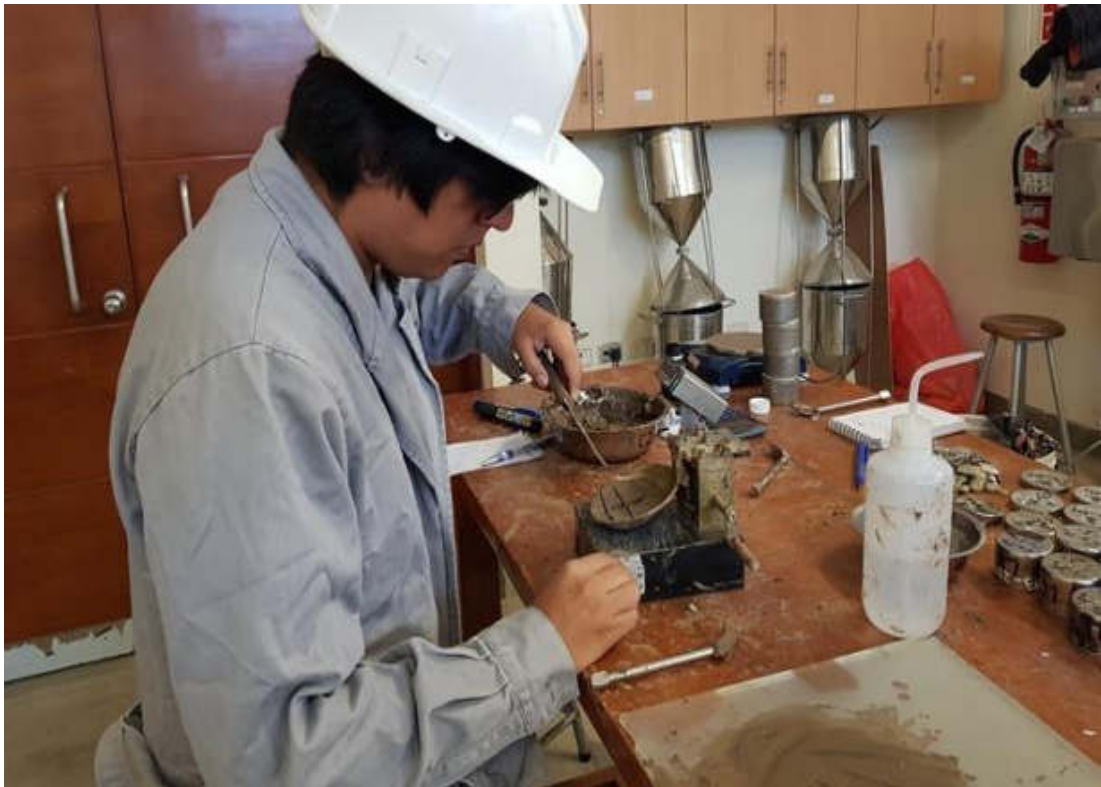
FOTOGRAFÍA N° 18: Se utilizó la Copa de Casagrande para realizar el ensayo de límite líquido, realizando los golpes respectivos que se encuentran en el intervalo requerido de 15-20; 20-25; 25-30 y 30-35.
