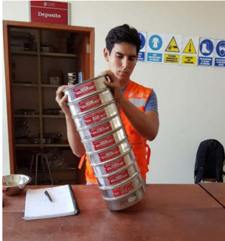
FOTOGRAFÍA N° 13: Se procede a realizar el tamizado de la muestra, moviéndola homogéneamente de un lado para otro, 60 veces por 1 minuto.
