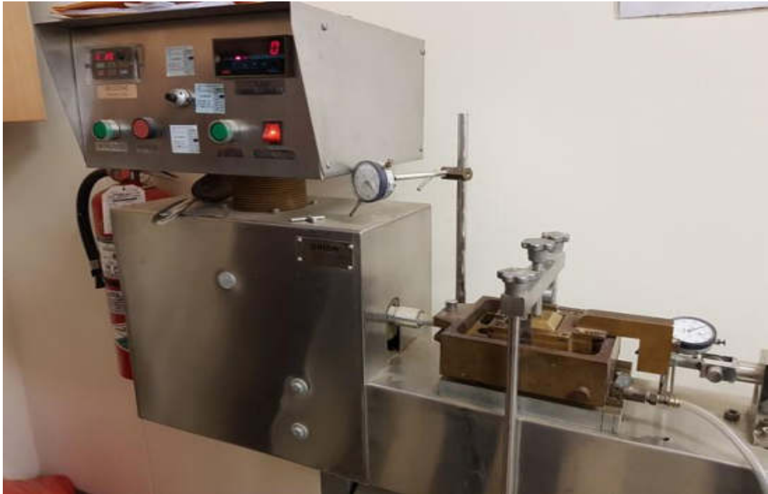
FOTOGRAFÍA N° 59: Se enciende la máquina y se anotan los valores que tanto la maquina como el dial arrojen, teniendo en cuenta que la maquina trabaja con una velocidad de 0.25 mm/min.
