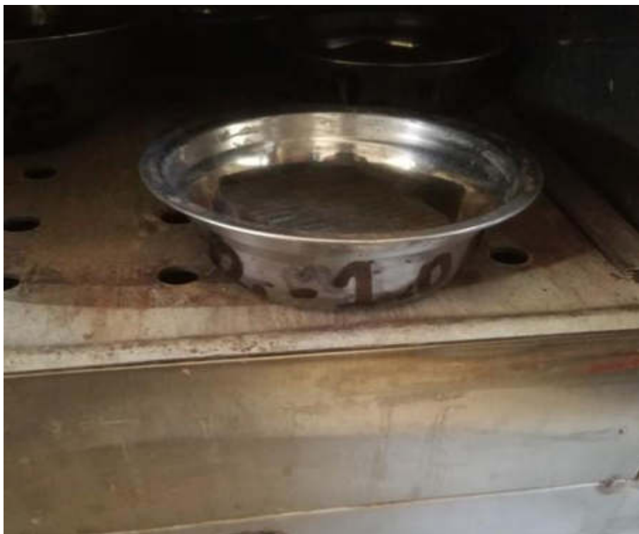
FOTOGRAFÍA N° 64: Por último, se llevó al horno por 24 horas. Concluido este periodo de tiempo, se sacó la muestra y se volvió a pesar, esto con el fin de hallar el contenido de humedad.
