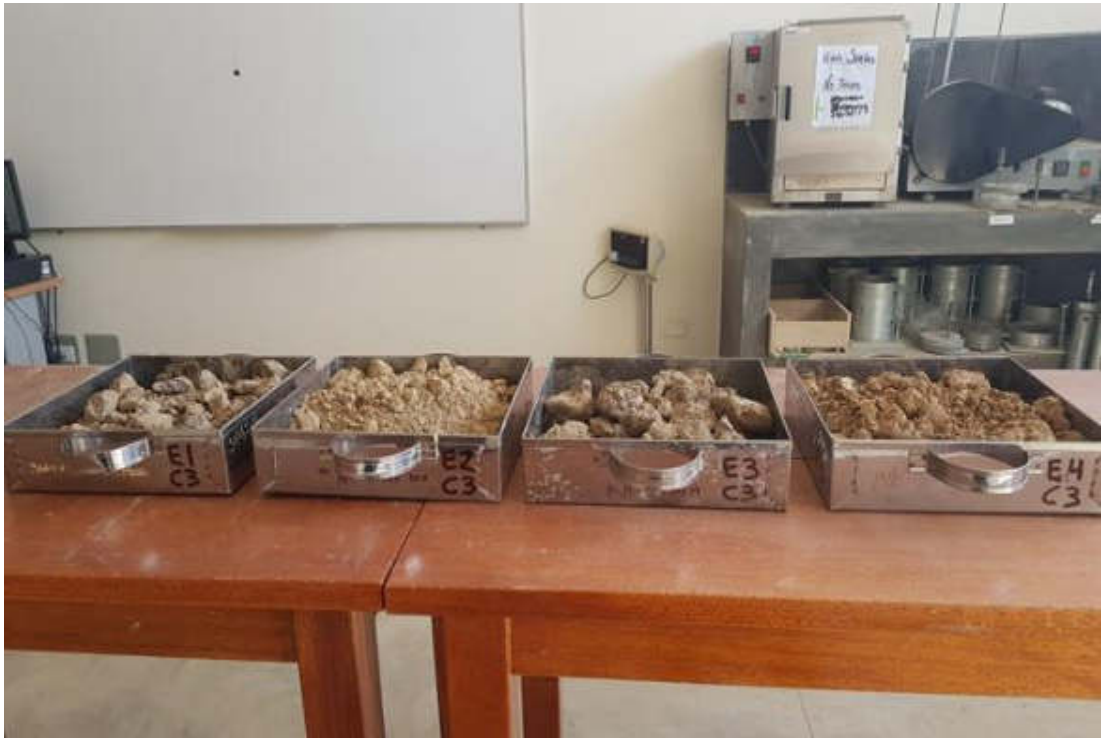
FOTOGRAFÍA N° 07: Las muestras se colocaron en bandejas, debidamente identificadas, para ser secadas al aire libre.
