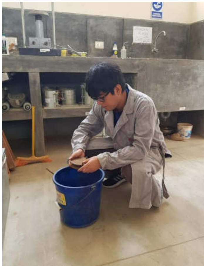
FOTOGRAFÍA N° 48: Se colocó en baldes identificados con el tiempo que se va a saturar la muestra.
