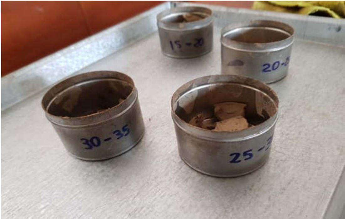
FOTOGRAFÍA N° 19: Encontrado los rangos, se colocan en sus respectivas taras, estas fueron llevadas al horno por 24 horas, se volvieron a pesar y se halló su contenido de humedad.
