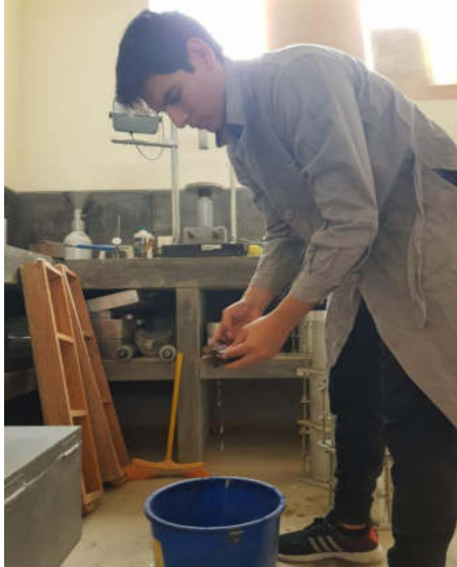
FOTOGRAFÍA N° 51: Concluido el tiempo establecido, se sacaron los moldes que se encontraban saturándose.
