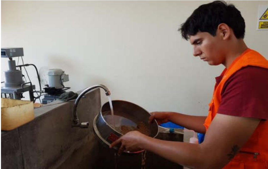
FOTOGRAFÍA N° 11: Con los 200 g se procede con ayuda del tamiz N°200 (de dimensión mayor al estándar) a lavar la muestra.
