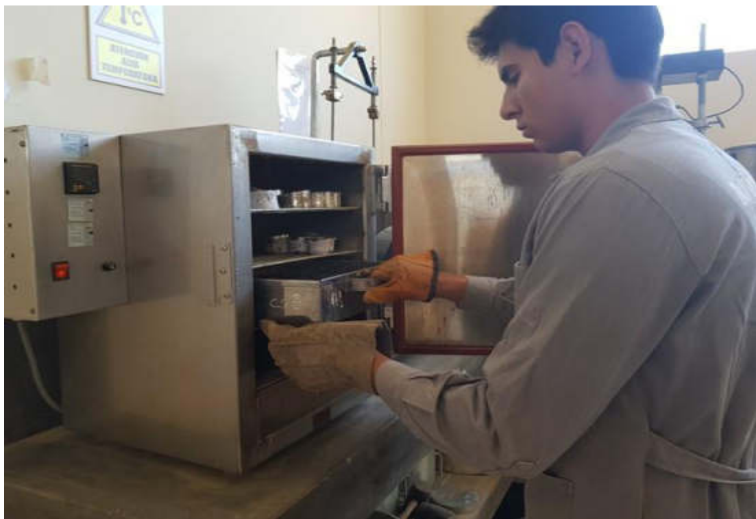
FOTOGRAFÍA N° 04: Con los implementos adecuados, una vez concluido el tiempo, se sacó la bandeja con taras del horno con sumo cuidado.
