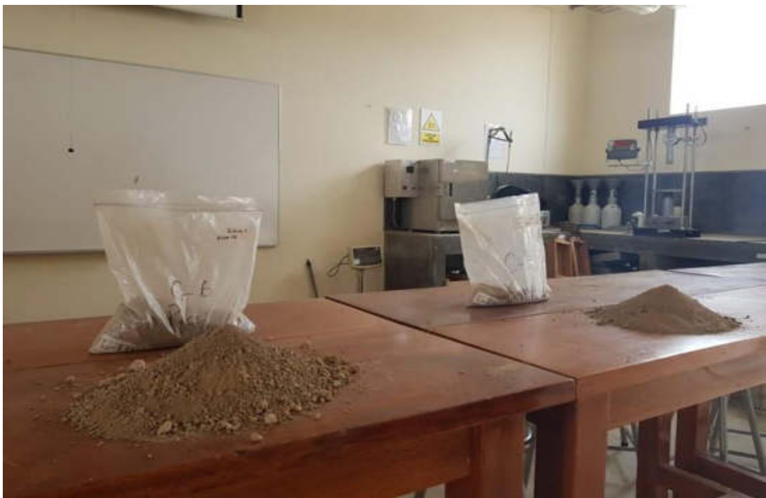
FOTOGRAFÍA N° 08: Seco el suelo, se procedió a disgregar el terreno. Concluido se colocaron las muestras en sus respectivas bolsas ziploc, debidamente identificadas. Se colocó un poco de muestra sobre una superficie plana para realizar el cuarteo.
