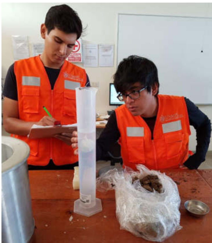
FOTOGRAFÍA N° 44: Con sumo cuidado se toma los valores dados, y la muestra se lleva al horno por 24 horas.
