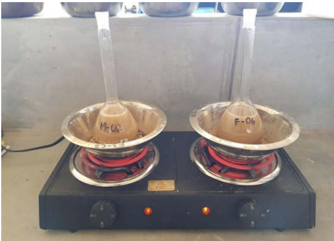
FOTOGRAFÍA N° 36: Las fiolas son colocadas en la cocina, una vez producida la ebullición en estas se sacan y se dejan enfriar.
