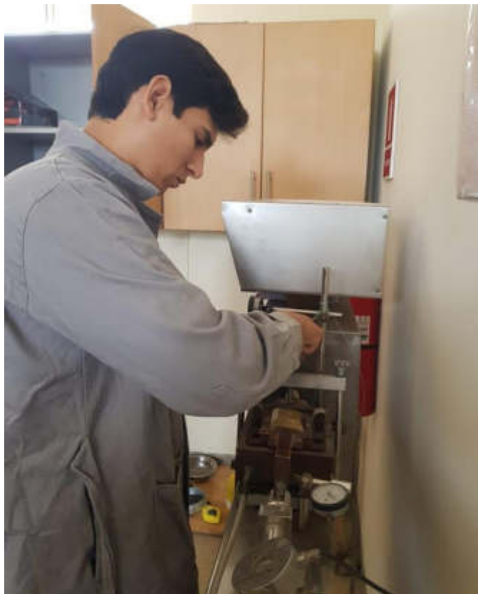
FOTOGRAFÍA N° 56: Se ensambla la caja de corte directo.
