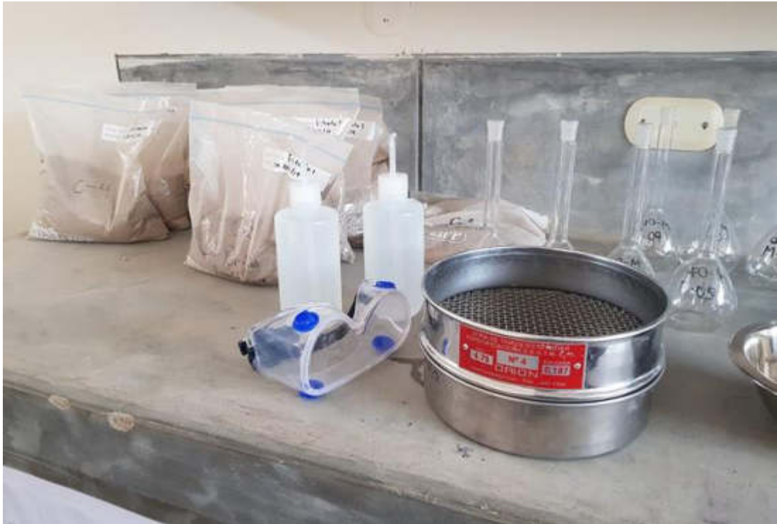
FOTOGRAFÍA N° 33: Se utilizó la malla N°4 para realizar el ensayo, con la muestra que pase esta malla.
