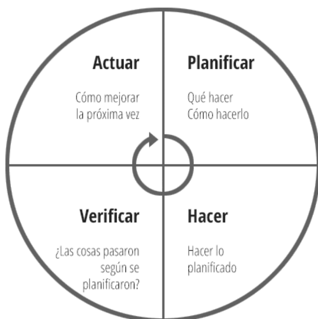
Figura 2. Representación esquemática del ciclo de Deming o método PDCA
