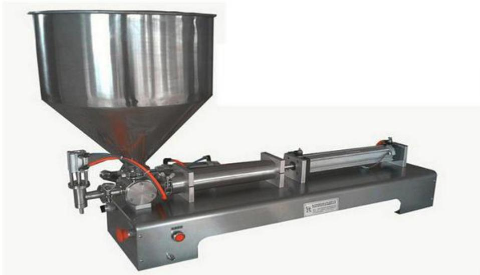
Figura 50. Máquina llenadora para máquina impactadora.
