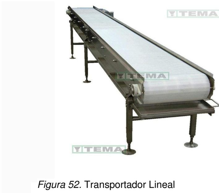
Figura 52. Transportador Lineal
