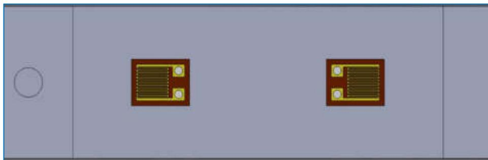
**Figura N° 54:** Extensómetro en paralelo en una celda de carga
