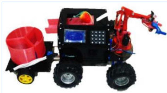
**Figura N° 21:** Robot Móvil recolector de fresas
