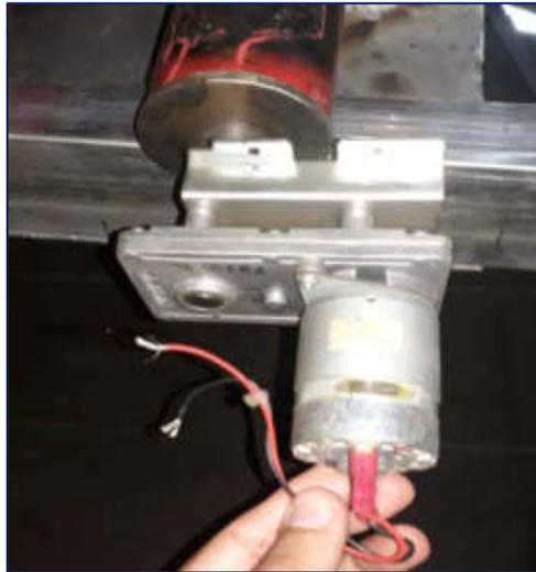
**Figura N° 159:** Motor reductor acoplado en la parte final del tornillo sin fin
