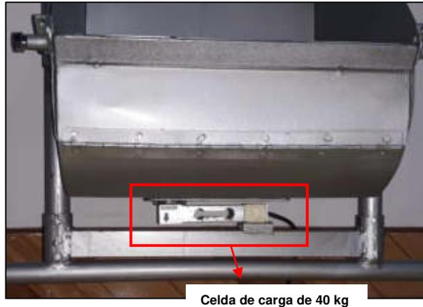
**Figura N° 153:** Celda de carga de 40 kg
