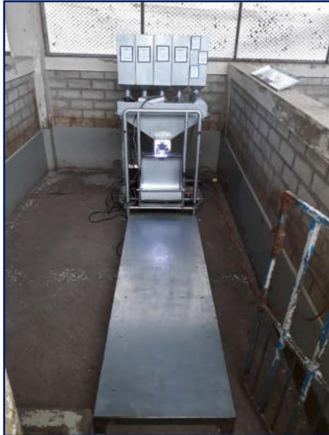
**Figura N° 221:** Estructura de pesaje, identificación por colores y dosificador de comida
