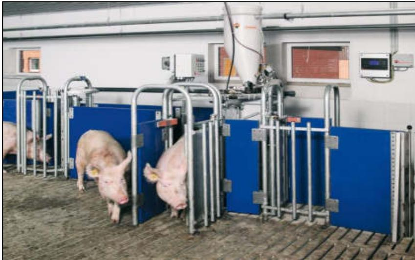
**Figura N° 39:** Sistema de alimentación y manejo: Alimentación controlada por ordenador Callmatic 2: Hasta 60 cerdas se pueden alimentar
