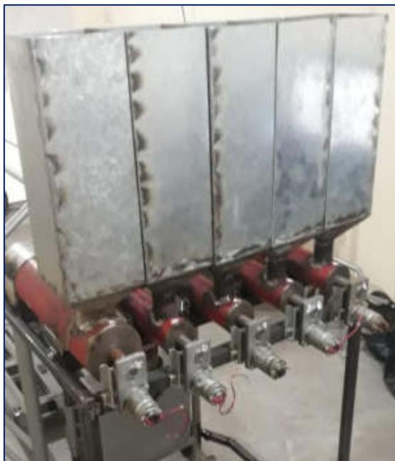
**Figura N° 160:** Acoplamiento de cada tornillo sin fin con su respectivo motor reductor
