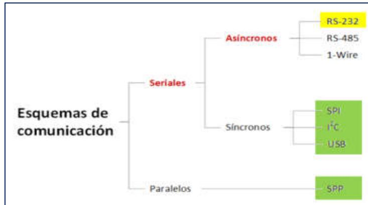
Figura N° 87: Esquema de las comunicaciones seriales y paralelos
