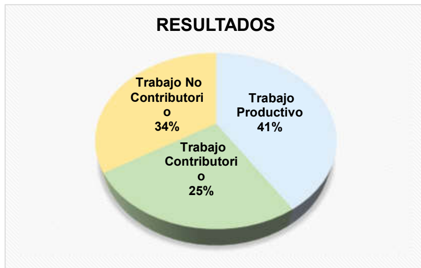
Figura 26 Resultados de la partida de vaciado de concreto para pavimento rígido
