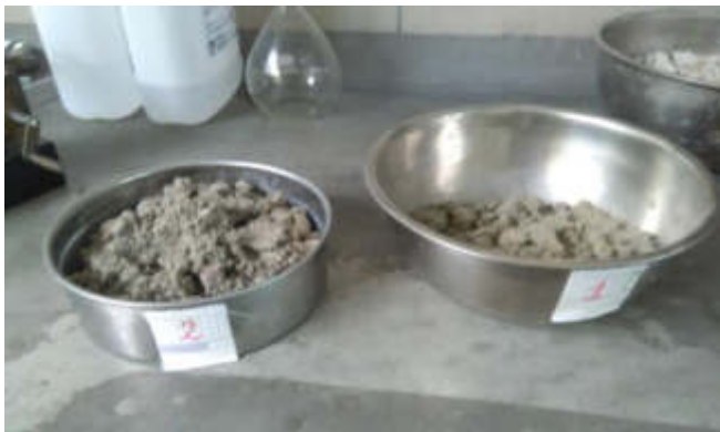
Ensayo de contenido de humedad: Preparación de la muestra
