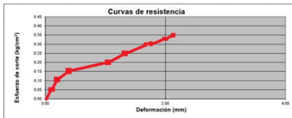
Figura 7: Plantilla Curva de resistencia. Fuente: Recuperado del Ensayo de Corte Directo (UNI, 2006)
