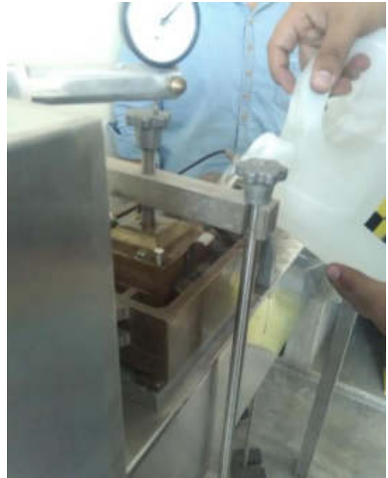
Colocación de agua esterilizada en la caja de corte (para el drenado de la muestra)
