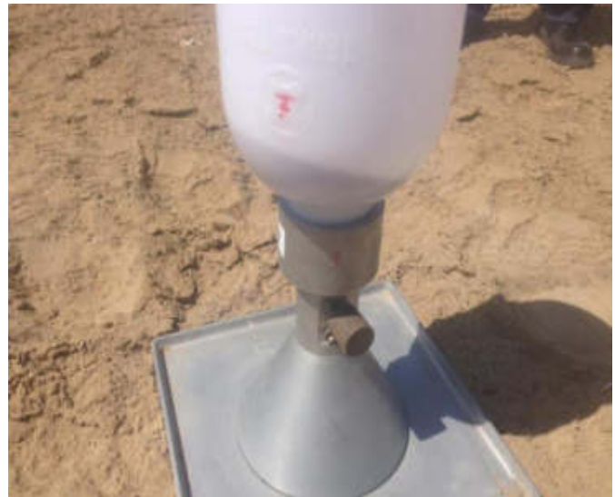
Relleno del hueco con arena de densidad conocida
