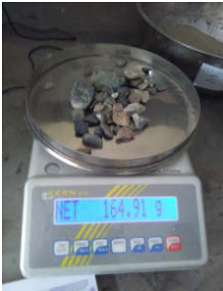
Peso de la grava existente
