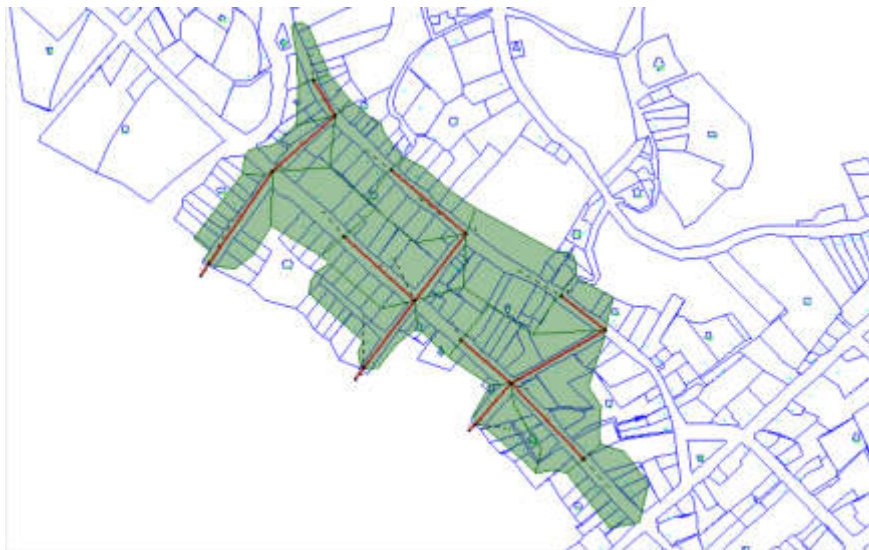
Figura 30. Modelamiento del sistema de alcantarillado, tres líneas de colectoras centrales con sus salidas de evacuación (Outfall), Tr = 10 años, software sewergems
