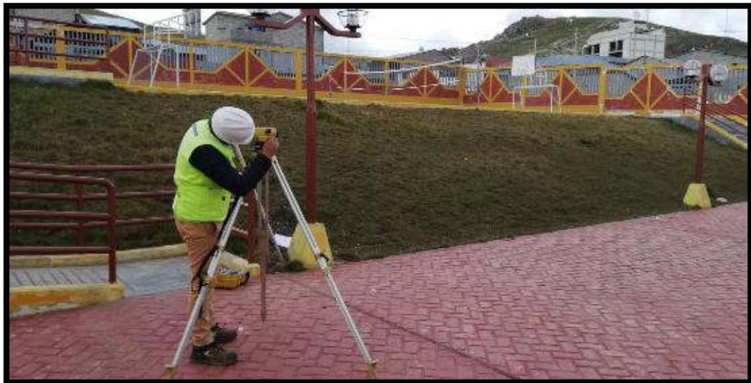
Figura 174. Medición de la pendiente del módulo V
