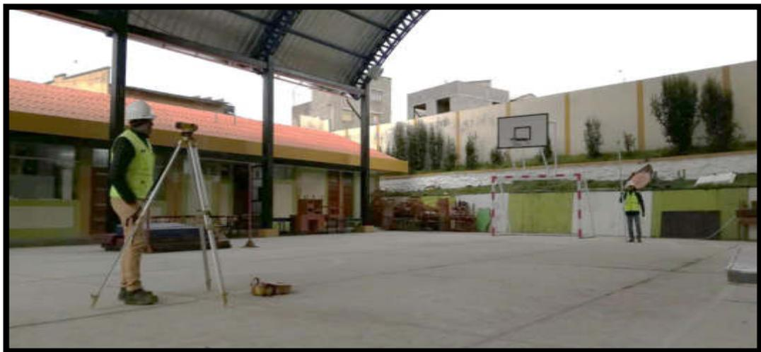
Figura 107. Cálculo de la pendiente del módulo III
