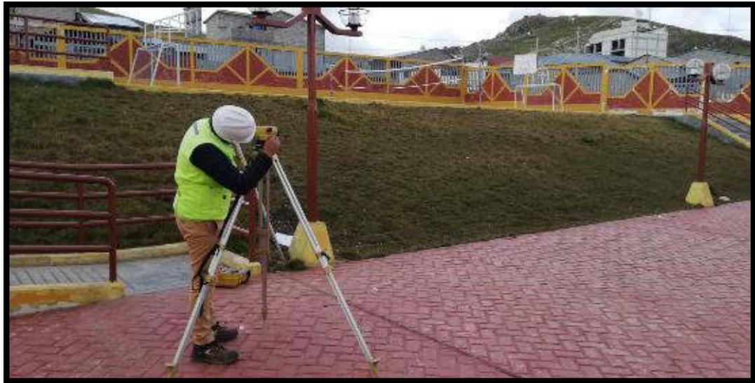
Figura 130. Cálculo de la pendiente del módulo I
