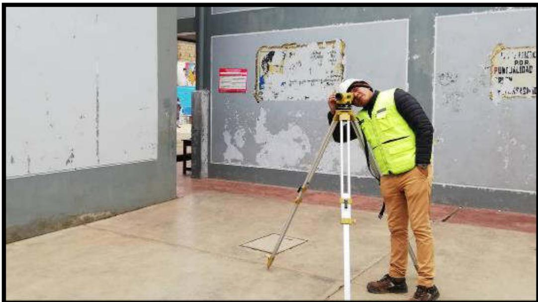
Figura 219. Medición de la pendiente del módulo II
