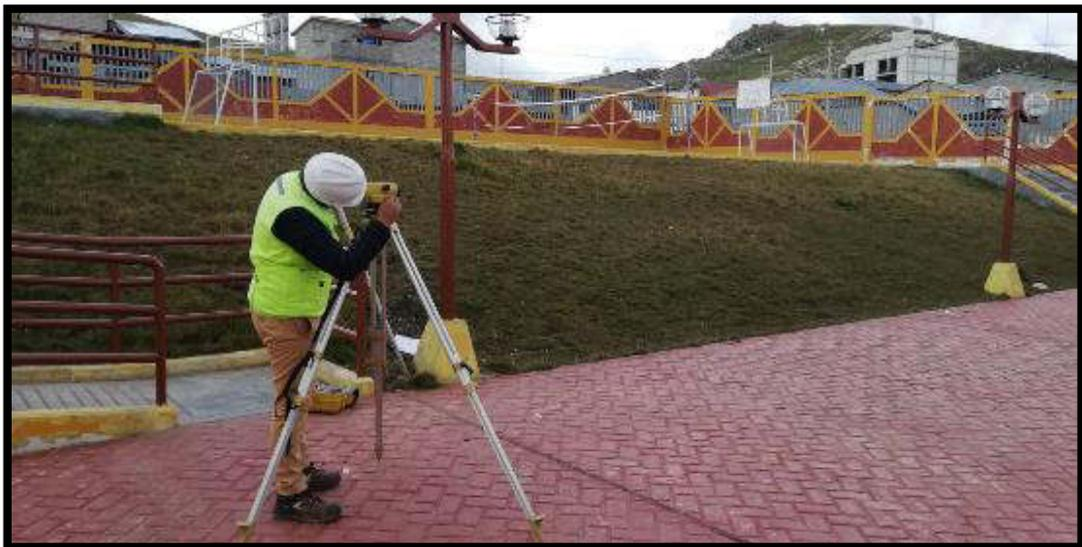
Figura 196. Medición de la pendiente del módulo VII
