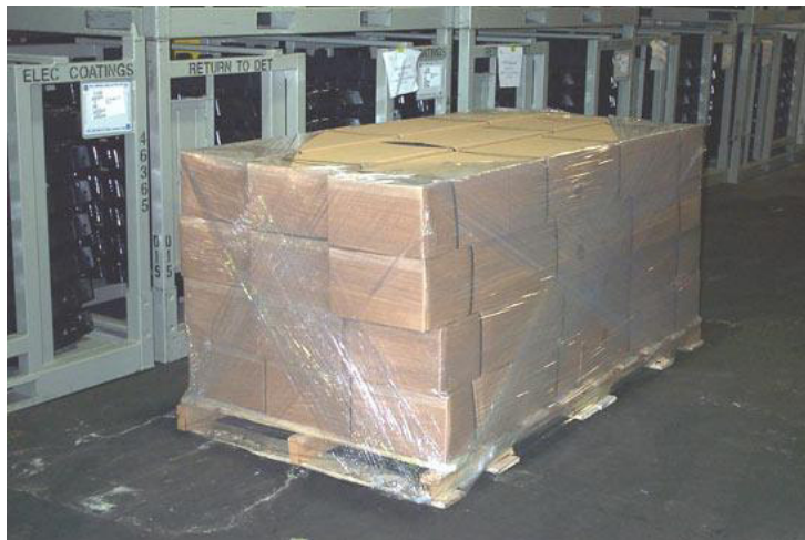
Figura 15 Paletización con Strech Film
