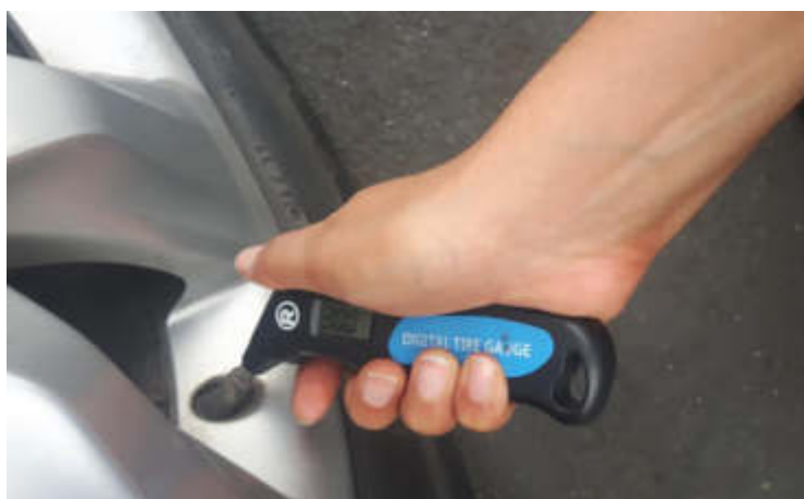
Figura 3.5 Nivelación de la presión de las llantas a 30psi. Elaboración: el autor
