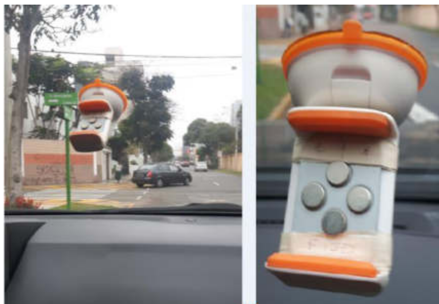
Figura 3.2 Montura Daikū modificada con imanes añadidos. Elaboración: el autor
