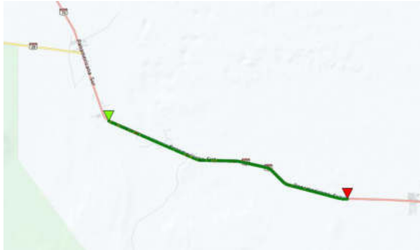
Figura 3.8 Visualización de IRI Roadroid Panam. Sur km 1135-1141 (Ica – Nazca) Fuente: Servidor de Roadroid. Elaboración: el autor
