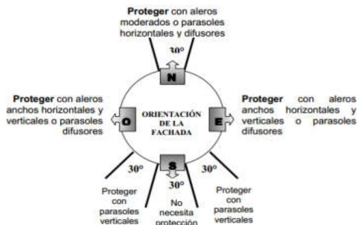
Figura N°81: Indicación sobre los distintos tipos de protección a utilizar sobre las ventanas para evitar deslumbramientos según orientación de la fachada en donde el aventanamiento está emplazado
