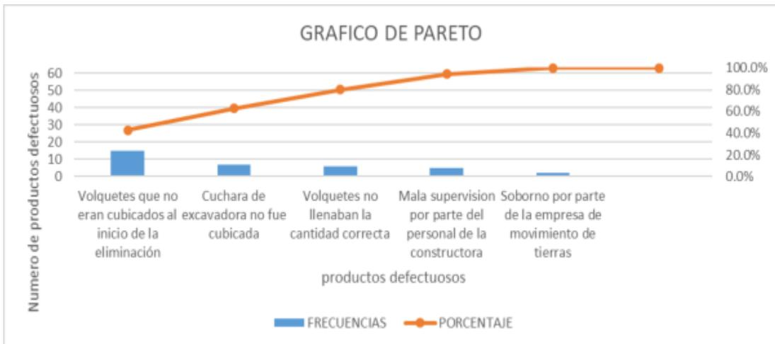
Figura 14: Gráfico de diagrama Pareto en la excavación y eliminación masiva del proyecto inmobiliario Géminis
