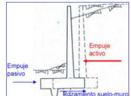
De igual forma el chequeo al **Deslizamiento** se puede realizar calculando **La Fuerza de Roce (Fr)**, que es la resistencia entre el suelo y la base del muro :
