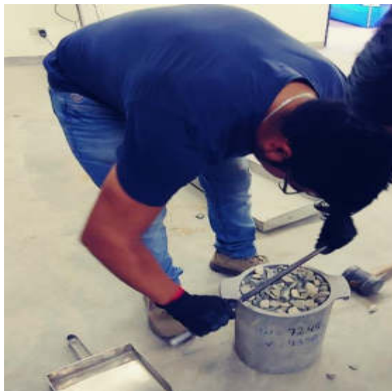
Figura N° 13: Enrase del Agregado Grueso
