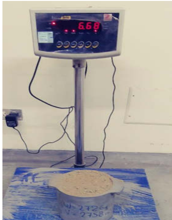
Figura N° 16: Peso de la muestra compactada del Agregado Fino
