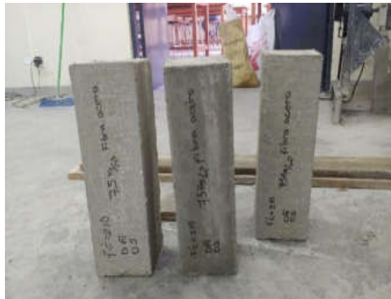
Figura N° 47: Vigas sacadas del curado
