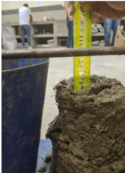
Figura N° 57: Medición del Slump
