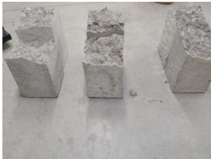
Figura N° 61: Rompimiento de las Vigas
