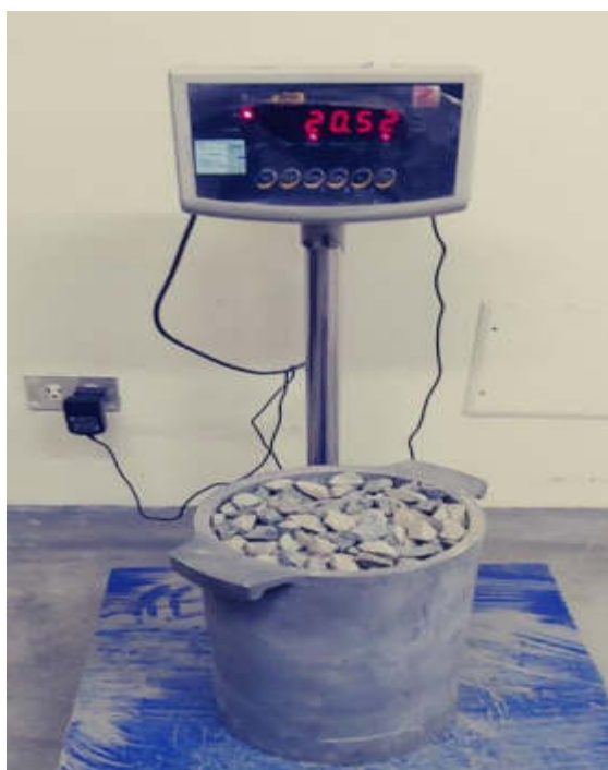
Figura N° 17: Peso de la muestra suelta del Agregado Grueso
