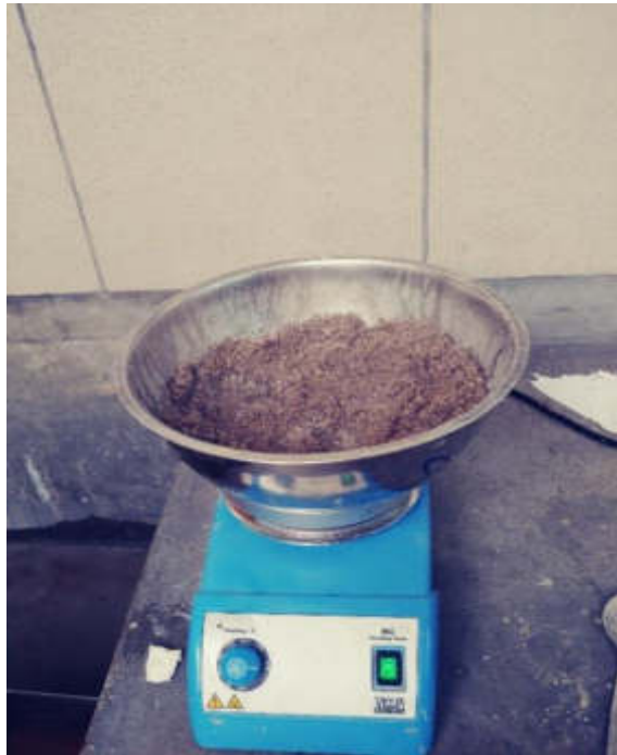
Figura N° 22: Cocina eléctrica para hallar el peso superficialmente seco del agregado fino
