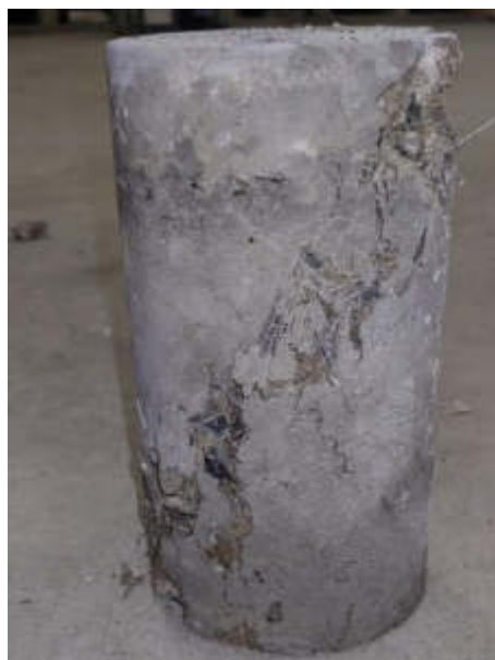
Figura N° 46: Probeta de concreto de 105 kg/m 3 de fibra de acero
