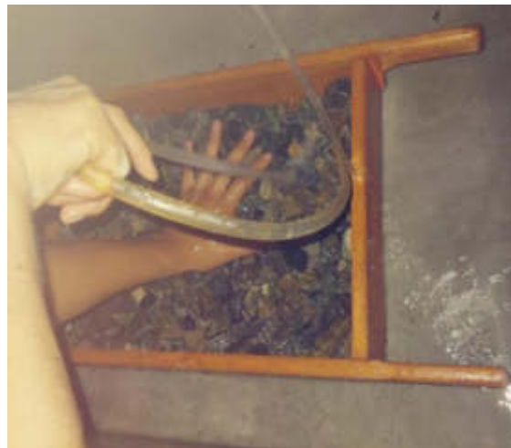
Figura N° 8: Lavado del Agregado Grueso
