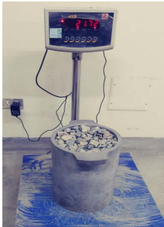
Figura N° 14: Peso de la muestra compactada del Agregado Grueso
