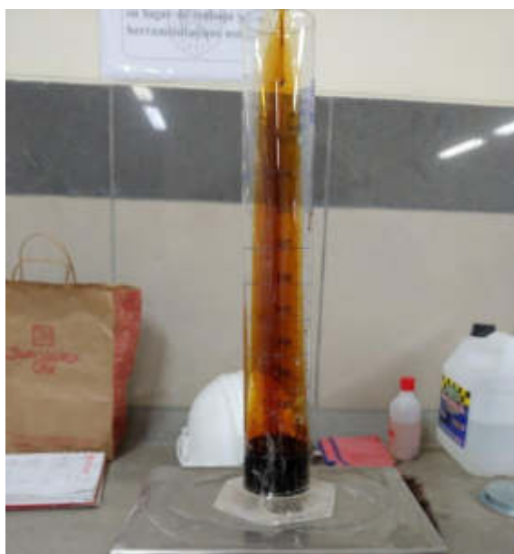
Figura N° 29: Peso del Aditivo Plastiment HE 98
