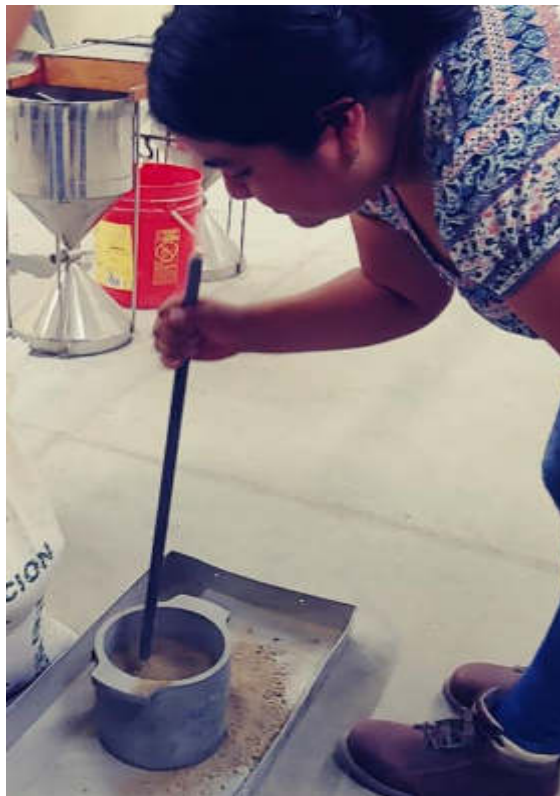
Figura N° 15: Compactación de la segunda capa del Agregado Fino
