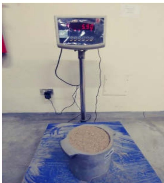
Figura N° 18: Peso de la muestra suelta del Agregado Fino
