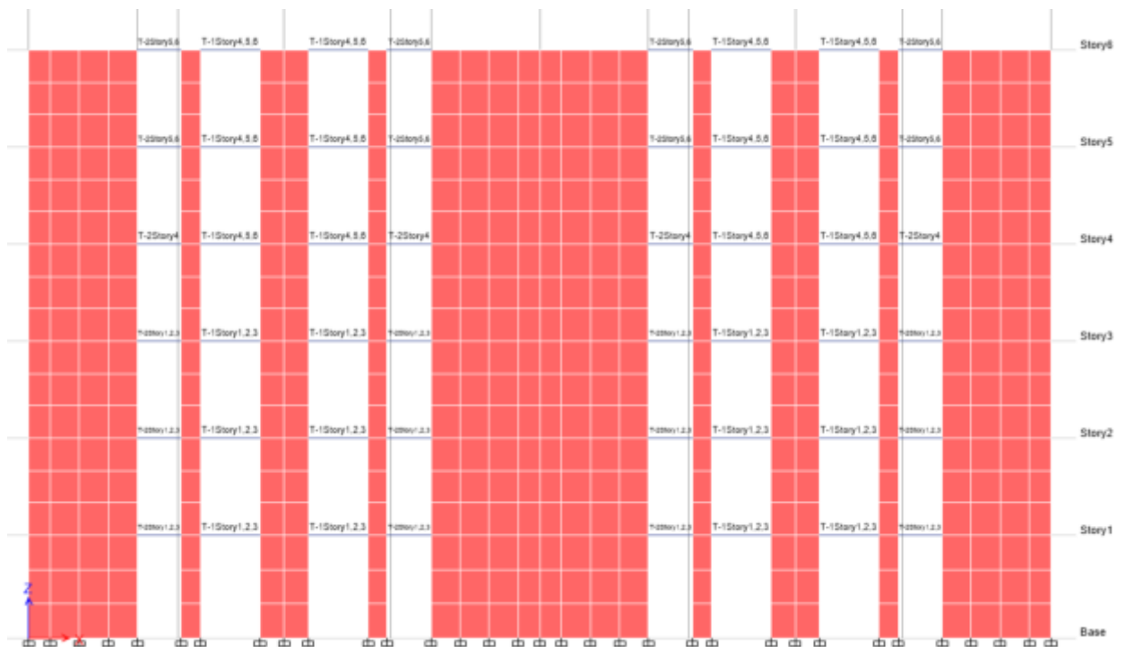
Figura 52. Reasignación de las secciones de viga con refuerzo de acero Fuente: ETABS
