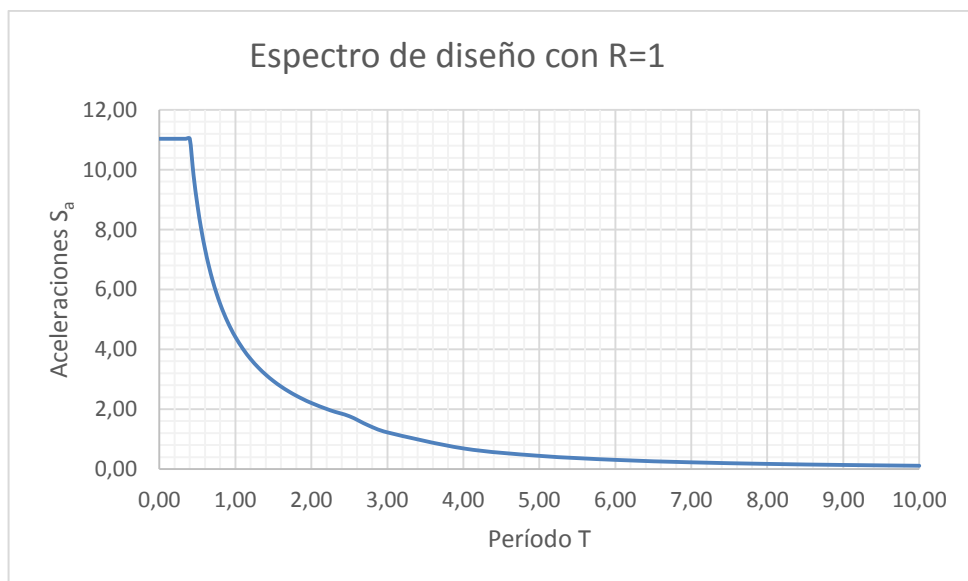
Figura 36. Espectro de diseño con factor R=1
