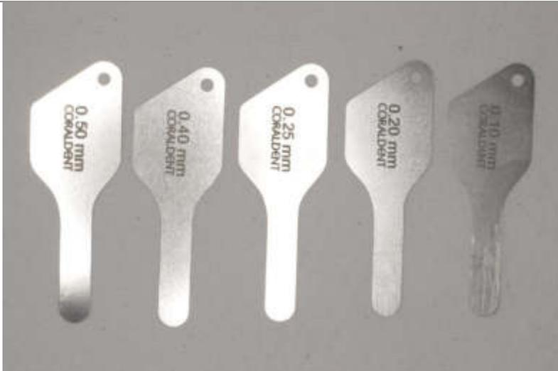
Calibrador de láminas galgas métricas.
