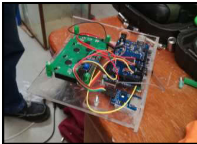
Figura 49. Proceso de instalación del Arduino, LCD y lectora micro SD
