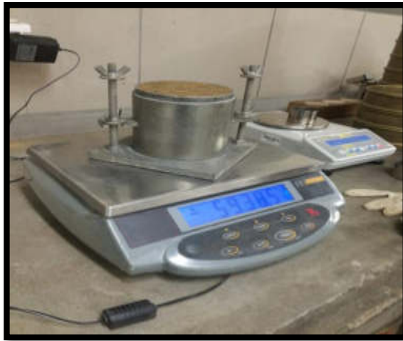
Se obtuvo el peso de la muestra y el molde con ayuda de la balanza. (Laboratorio de Mecánica de suelos de la USMP 2018) Lima, La Molina
