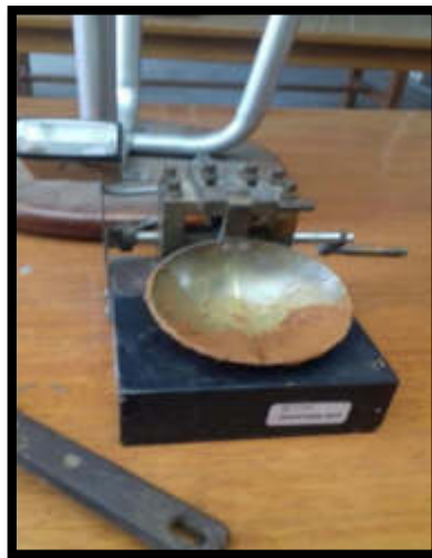
Utilización de la Cuchara de Casa Grande para determinar el límite líquido de la arcilla de Huánuco. (Laboratorio de Mecánica de suelos de la USMP 2018) Lima, La Molina
