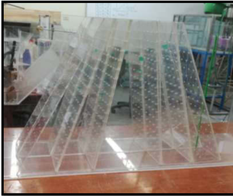
Figura 44. Compartimientos de acrílico que conforman el cuerpo de la presa
