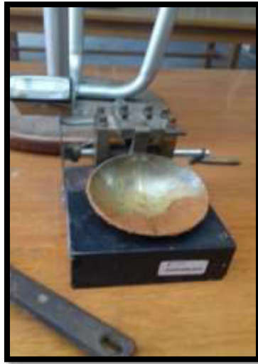
Figura 28. Ensayo de límite líquido de la arcilla de Huánuco
