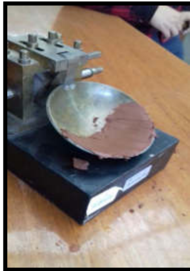
Utilización de la Cuchara de Casa Grande para determinar el límite líquido de la arcilla de Cerro de Pasco. (Laboratorio de Mecánica de suelos de la USMP 2018) Lima, La Molina
