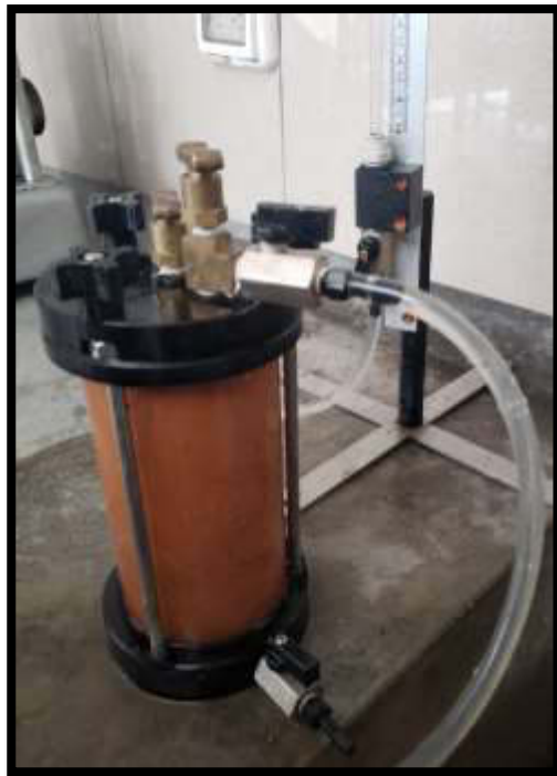
Figura 37. Ensayo de permeabilidad de la arcilla de Huánuco malla N°16
