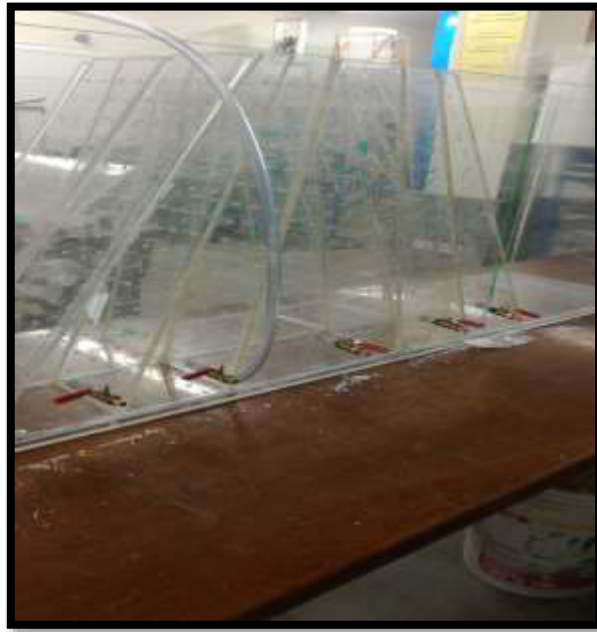
Figura 47. Instalación de piezómetros
