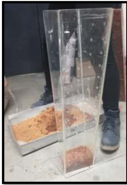
Figura 52. Proceso de compactación en los compartimientos de acrílico, para el núcleo de la presa
