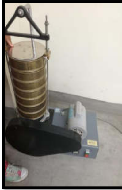
Utilización del tamizador portátil para las muestras de arcilla (Laboratorio de Mecánica de suelos de la USMP 2018) Lima, La Molina
