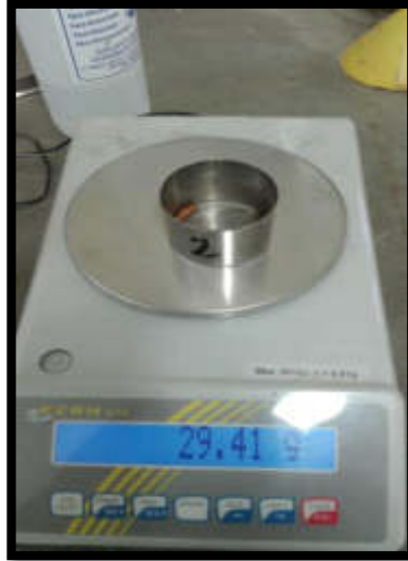
Utilización de balanza para pesar la muestra del ensayo de límite plástico. (Laboratorio de Mecánica de suelos de la USMP 2018) Lima, La Molina.
