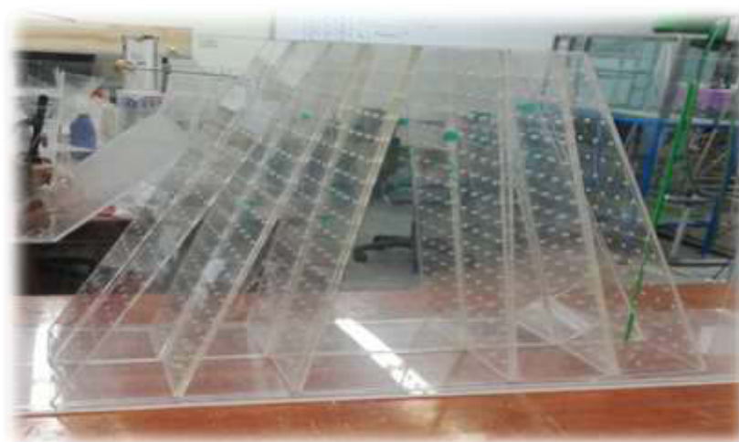
Figura 3. Modelo físico de una presa de tierra
