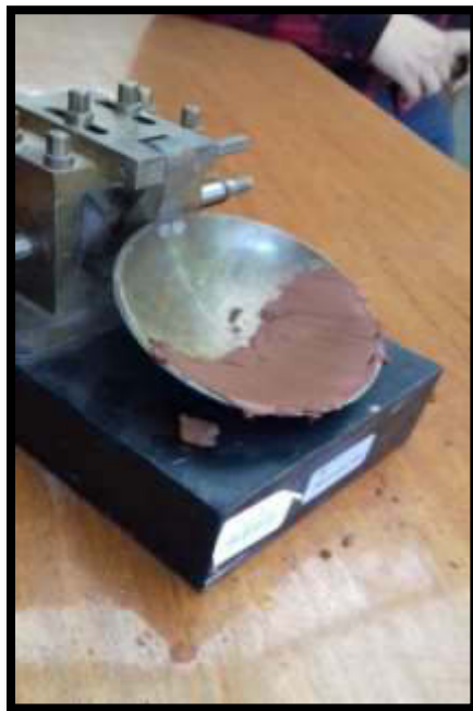
Figura 27. Ensayo de límite líquido de la arcilla de Cerro de Pasco
