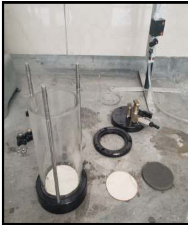
Figura 36. Permeámetro de carga variable
