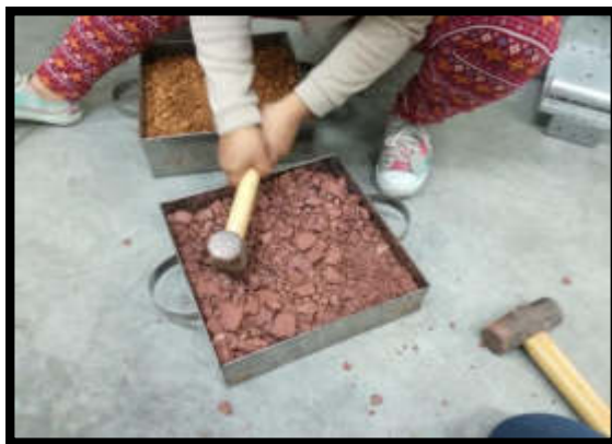
Proceso de trituración de la arcilla de Cerro de Pasco (Laboratorio de Mecánica de suelos de la USMP 2018) Lima, La Molina.
