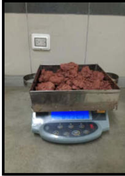
Utilización de la balanza para pesar la muestra de arcilla de Cerro de Pasco (Laboratorio de Mecánica de suelos de la USMP 2018) Lima, La Molina
