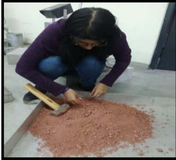
Proceso de trituración de la arcilla de Huánuco (Laboratorio de Mecánica de suelos de la USMP 2018) Lima, La Molina.
