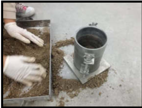
Colocación de la arena en el molde. (Laboratorio de Mecánica de suelos de la USMP 2018) Lima, La Molina.
