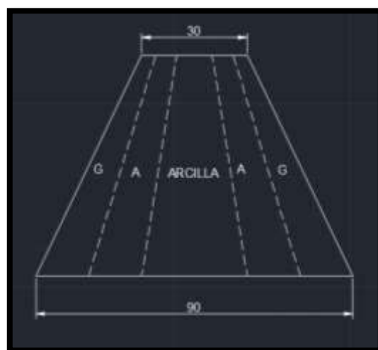
Figura 51. Componentes del cuerpo de la presa
