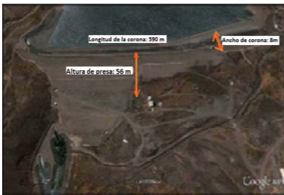
Figura 39. Dimensiones de la presa Yuracmayo
