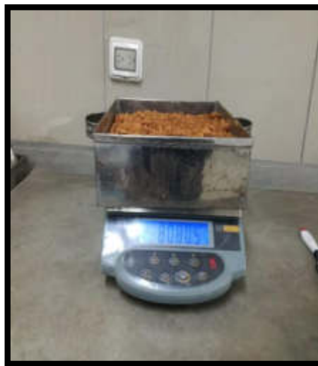
Utilización de la balanza para pesar la muestra de arcilla de Huánuco (Laboratorio de Mecánica de suelos de la USMP 2018) Lima, La Molina
