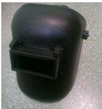
Figura N°21 Pantalla de soldadura
