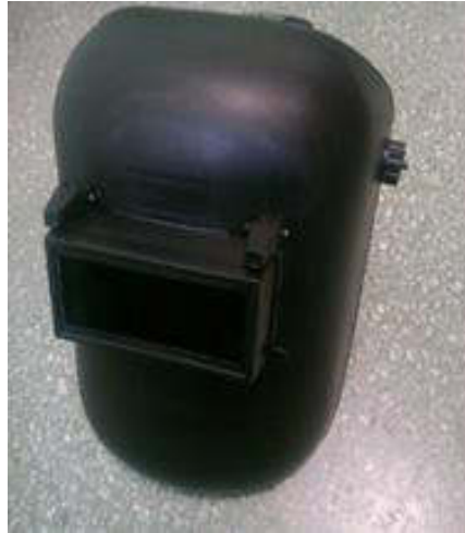
Figura N°21 Pantalla de soldadura Elaboración: los autores
