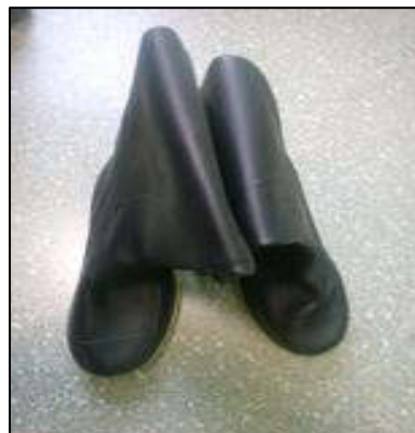
Figura N°35 Botas dieléctricas sin punta de acero
