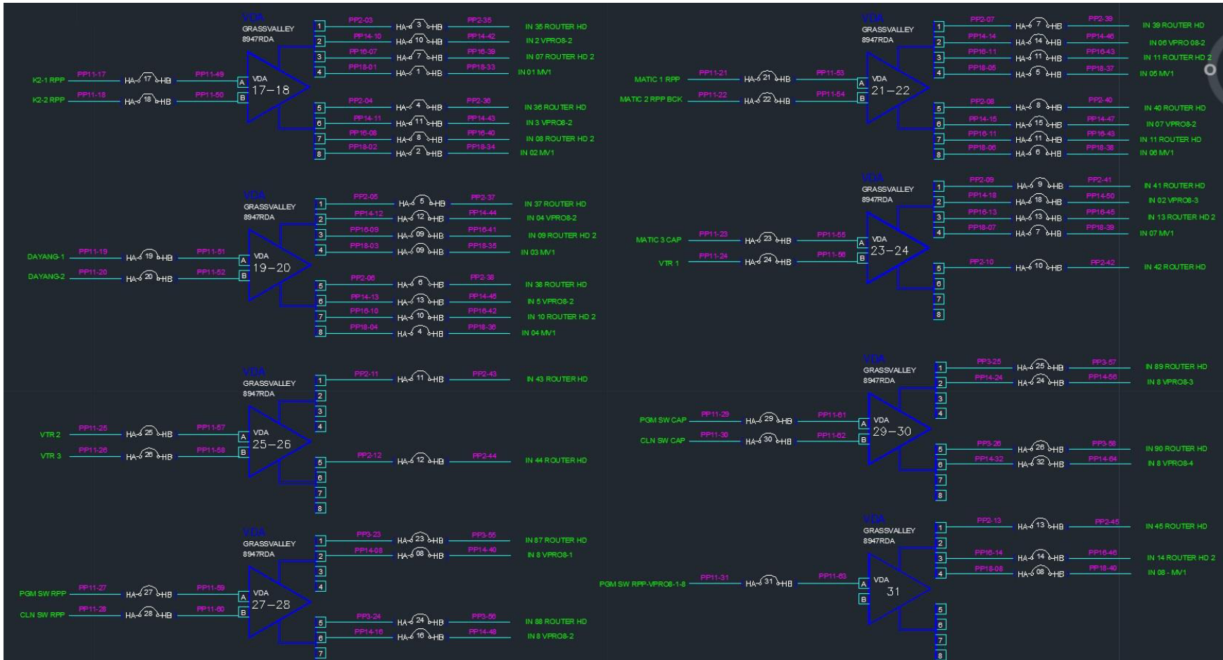
Figura 54. Diagrama de conexión de distribuidores de video del 17 al 31
