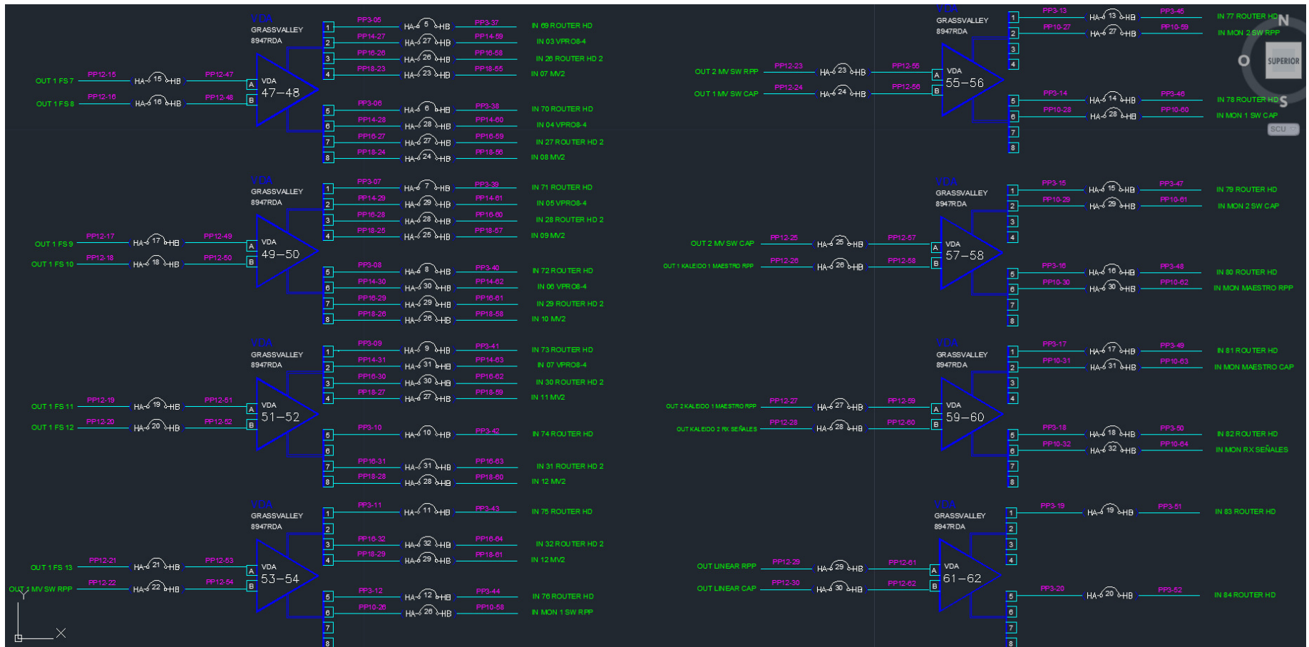
Figura 57. Diagrama de conexión de distribuidores de video del 47 al 62
