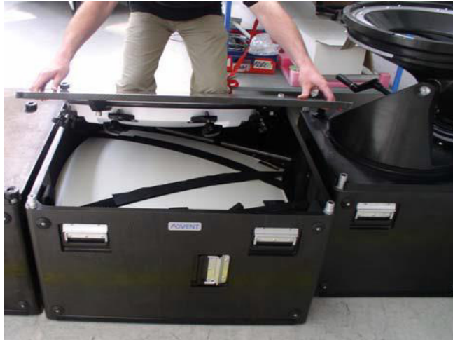
Figura 16. Instalación de pétalos
