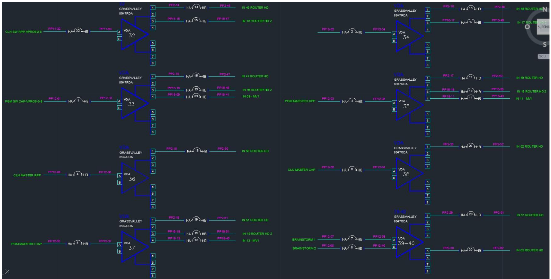
Figura 55. Diagrama de conexión de distribuidores de video del 32 al 40
