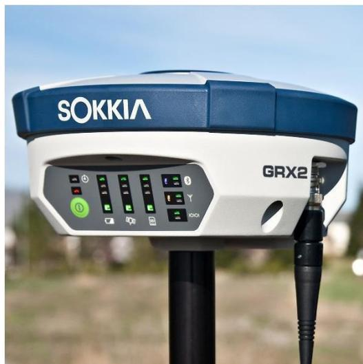
Figura 27. Receptor de GPS Sokkia – Modelo GRX2
