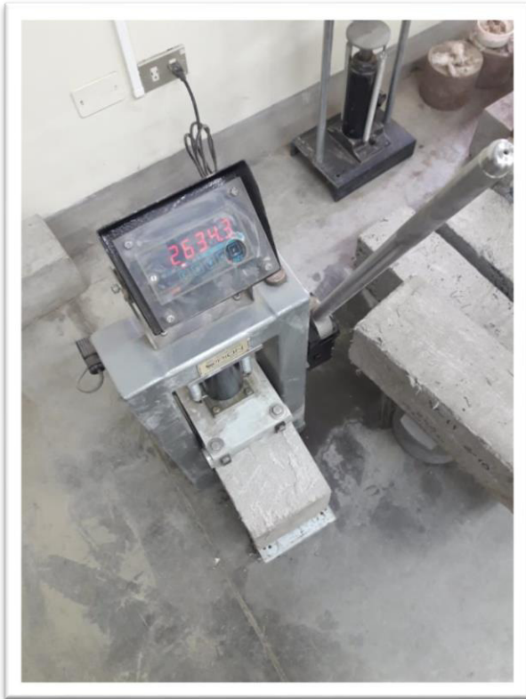
Foto 21: Ensayo de flexión en viguetas.
