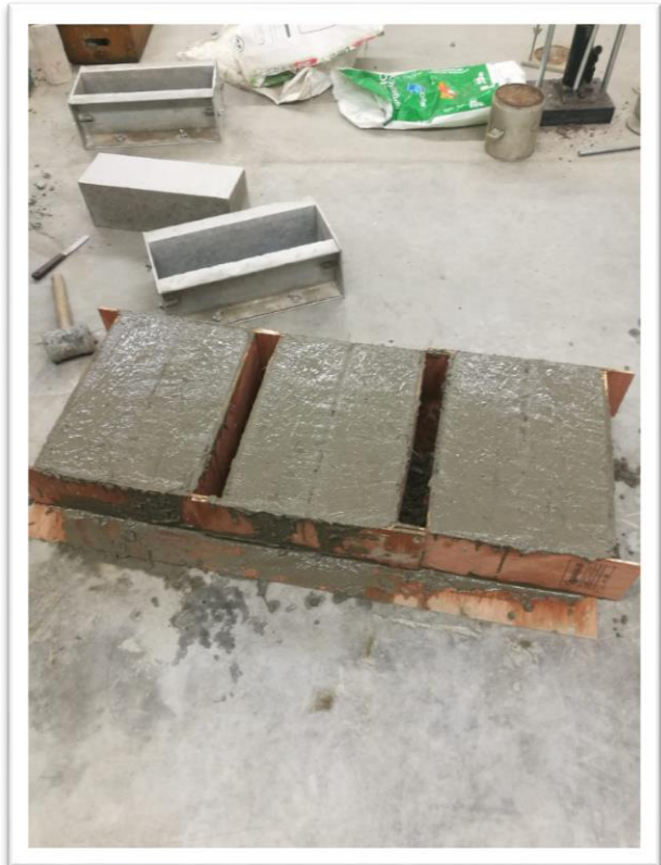
Foto 20: Viguetas elaboradas con fibra sintética.
