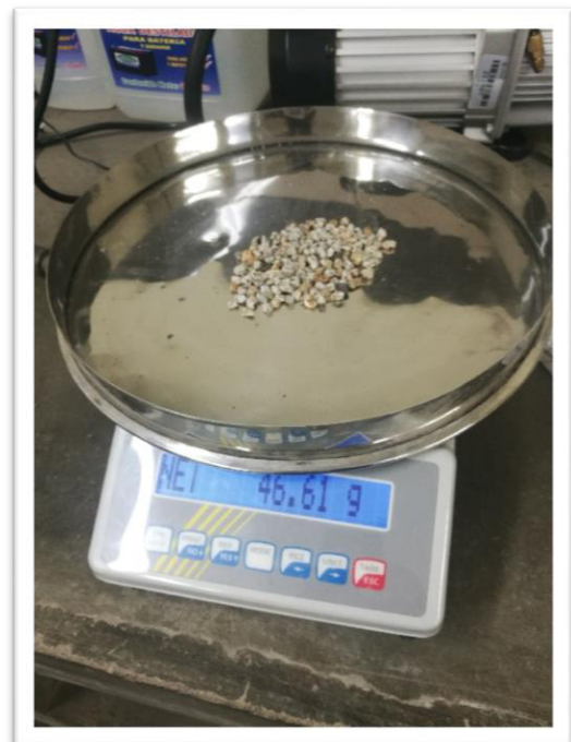
Foto 6: Obtención del peso retenido por cada tamiz.
