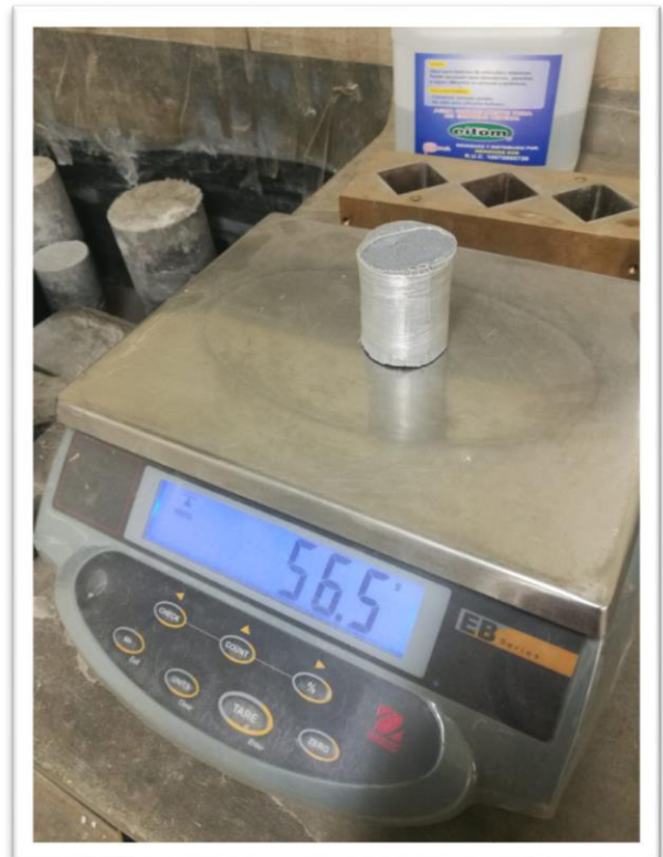
Foto 18: Obtención del peso de un paquete de fibra sintética para la dosificación
