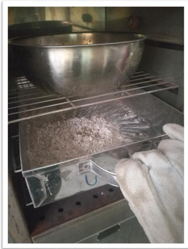
Foto 3: Extracción de la muestra seca del horno
