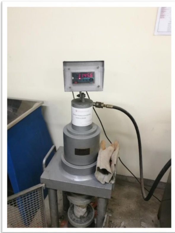
Foto 17: Ensayo de compresión a los 3 días en concreto patrón.
