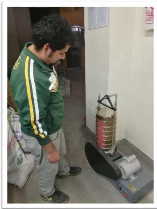
Foto 5: Realización del ensayo de granulometría.
