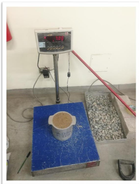
Foto 2: Pesando la muestra para determinar el peso unitario suelto.
