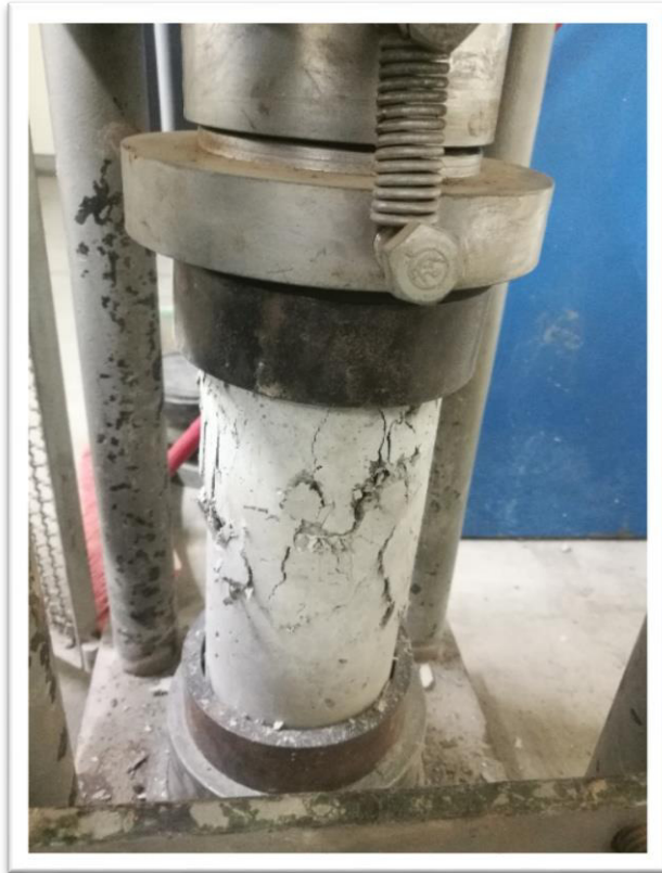
Foto 23: Deformación de la probeta con fibra sintética ante el ensayo de compresión.
