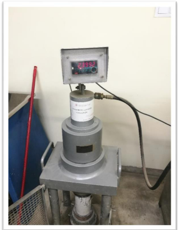
Foto 22: Ensayo a compresión en probetas con fibra sintética.
