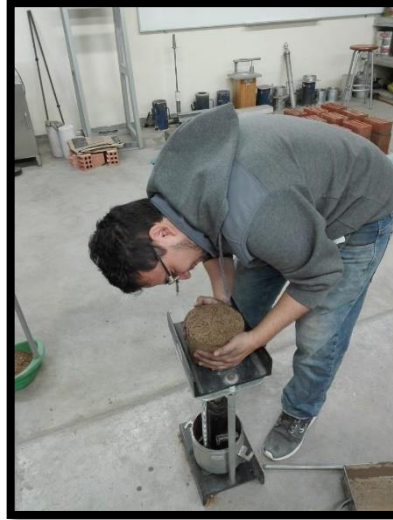
Fotografía 37.Extracción de la muestra compactada
