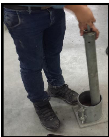
Fotografía 34. Compactación de la muestra
