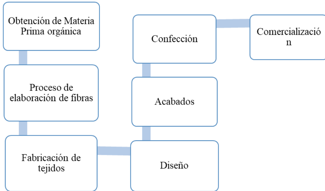
Figura N° 20 Proceso Productivo de las Toallas de bebé.
