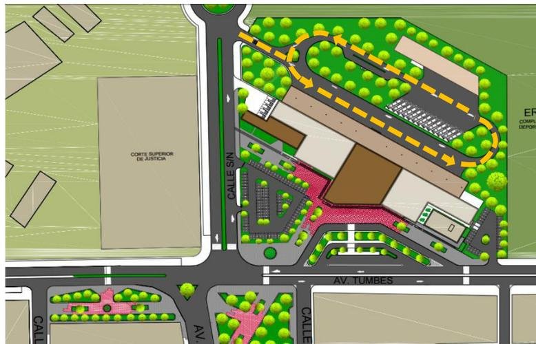
Figura N° 65: Esquema acceso y salida de los buses al terminal.
