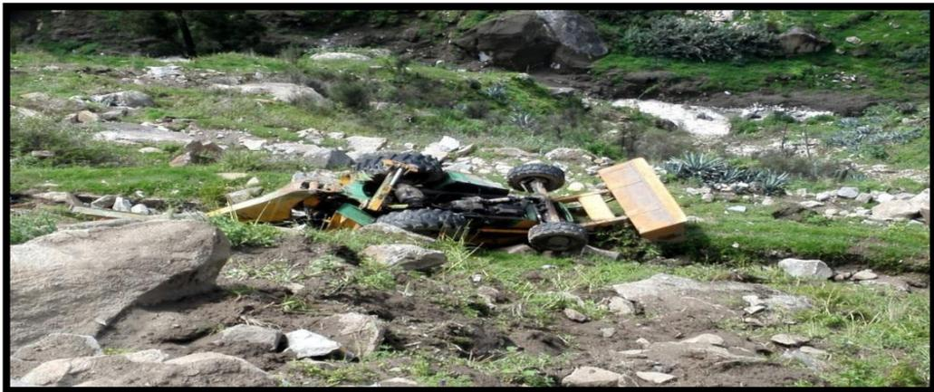
**Figura 34:** Maquinaria (retroexcavadora) contratada por la municipalidad para realizar trabajos de limpieza de derrumbes, siendo afectada por el mal estado de la vía, por los factores mencionados y más aún, por no contar con dimensiones mínimas de una carretera. Es por eso que se propone hacer un diseño de carretera de tercera clase.
