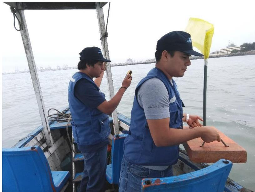
Toma de velocidades superficiales mediante un flotador
