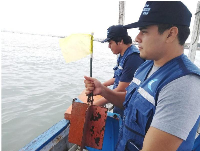
Medición de corrientes sub-superficiales mediante un flotador unido con un lastre
