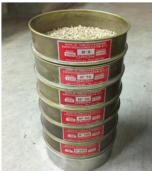
**Figura 30.** Tamices para tamizado de agregado fino [Fotografía de Jonatán Vera]. (Lima. 2018).
