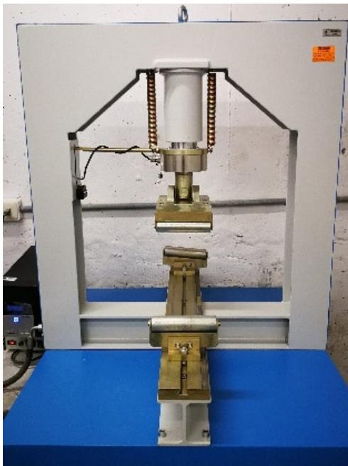
**Figura 24.** Máquina empleada durante el ensayo para determinar la resistencia a la flexión para una viga de concreto [Fotografía de Jonatán Vera]. (Lima. 2018).
