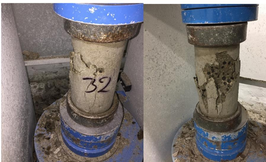
**Fotografía 17:** Ensayo de la resistencia a la compresión [Fotografías de Gina Quispe]. (Lima, 2018).
