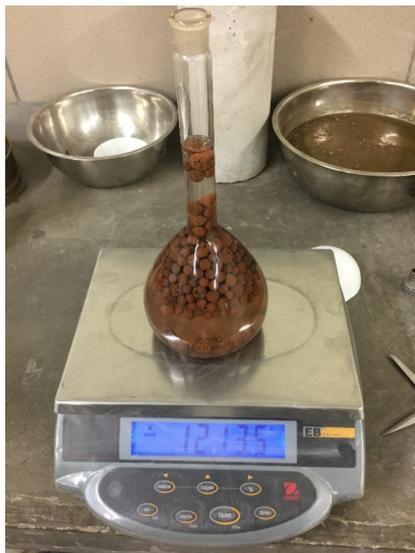
**Figura 45.** Muestra de agregado grueso en estado saturado superficialmente seco dentro de fiola con agua hasta la marca de calibración [Fotografía de Gina Quispe]. (Lima. 2018).
