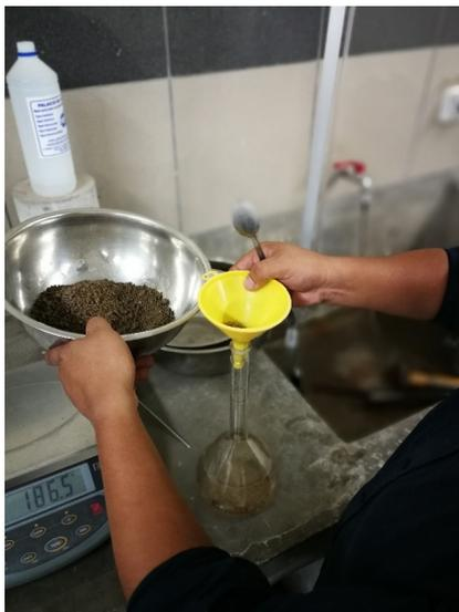
**Figura 46.** Muestra de agregado fino en estado saturado superficialmente siendo añadido lentamente en la fiola con agua para evitar dañar el frasco [Fotografía de Jonatán Vera]. (Lima. 2018).
