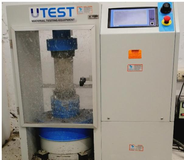
**Figura 20.** Equipo de ensayo de resistencia a la compresión
