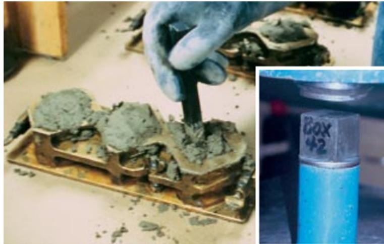
**Figura 4.** Se hacen cubos de 50 mm (2 pulg.) (izquierda) y se los prensan para la determinación de las características de resistencia del cemento. Recuperada de “Diseño y Control de Mezclas de Concreto” (Kosmatka, Kerkhoff, Panarese, & Tanesi, 2004, pág. 63)
