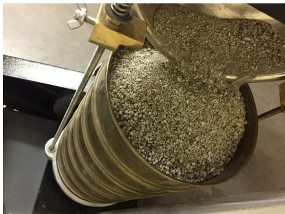
**Figura 32.** Agregado fino siendo añadido en tamices debidamente apilados
