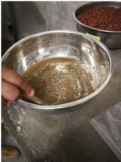
**Figura 41.** Agregado fino sumergido en agua luego de ser secado en el horno a 110 °C [Fotografía de Gina Quispe]. (Lima. 2018).
