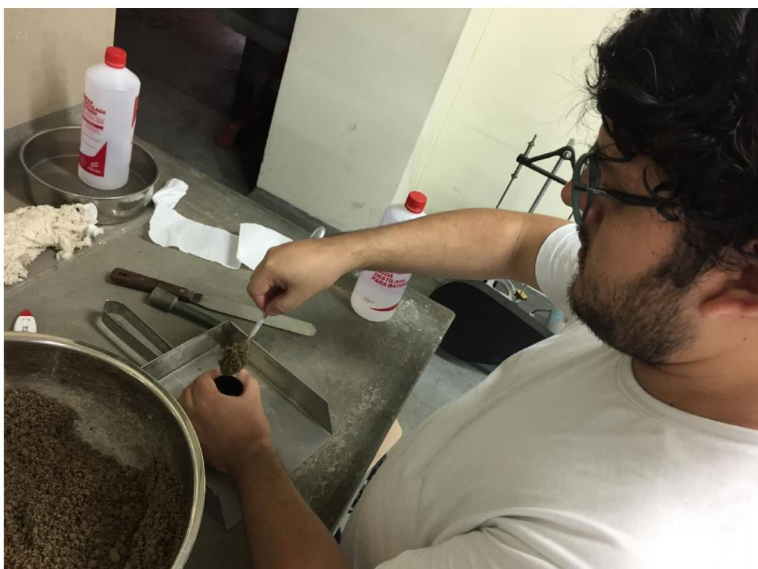
**Fotografía 4:** Proceso de verificación de estado saturado superficialmente seco del agregado fino, arena [Fotografía de Gina Quispe]. (Lima. 2018).
