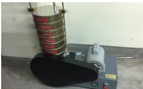
**Figura 33.** Agitador mecánico de tamices con agregado fino
