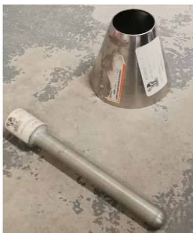
**Figura 12.** Molde y barra compactadora para los ensayos superficiales de humedad [Fotografía de Gina Quispe]. (Lima. 2018).
