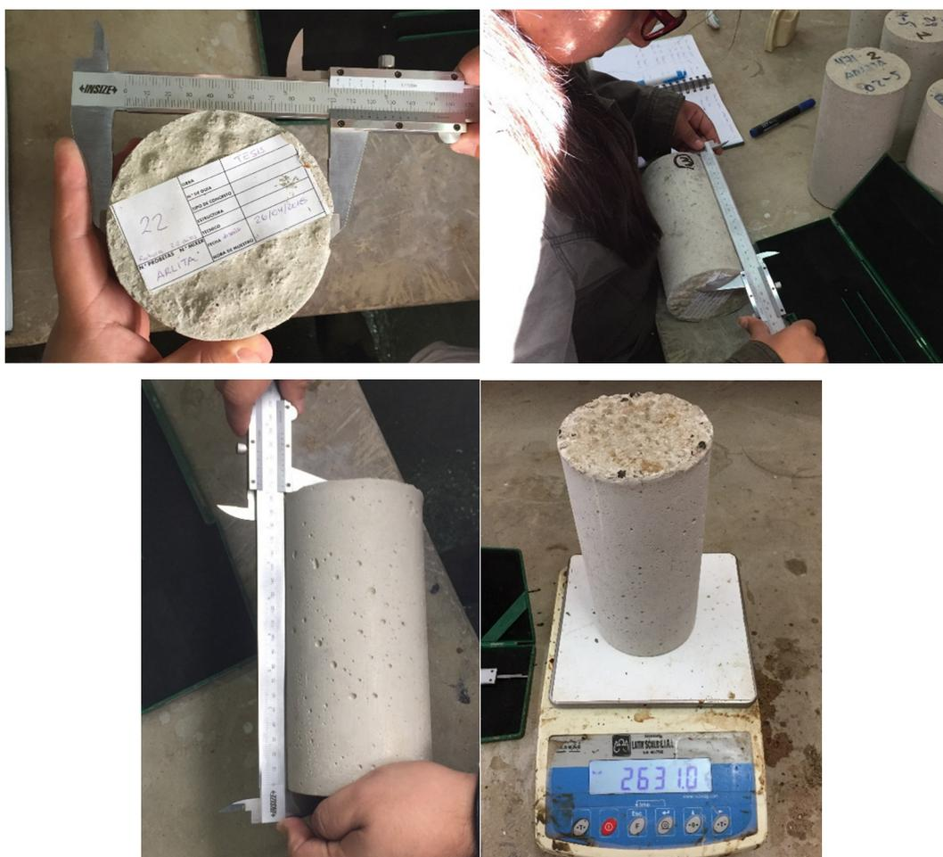
**Fotografía 16:** Medida y peso de las probetas para evolución del peso unitario en estado seco [Fotografías de Jonatán Vera]. (Lima. 2018).
