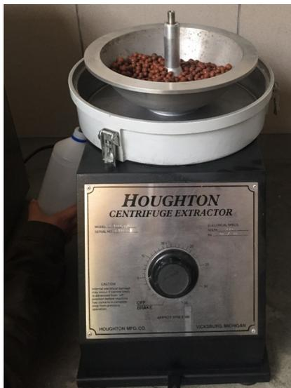
**Figura 38.** Agregado grueso liviano colocado en centrifuga luego de 72 horas sumergido en agua [Fotografía de Jonatán Vera]. (Lima. 2018).
