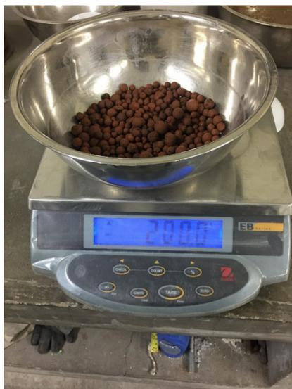
**Figura 43.** Muestra de agregado grueso en estado saturado superficialmente seco [Fotografía de Gina Quispe]. (Lima. 2018).
