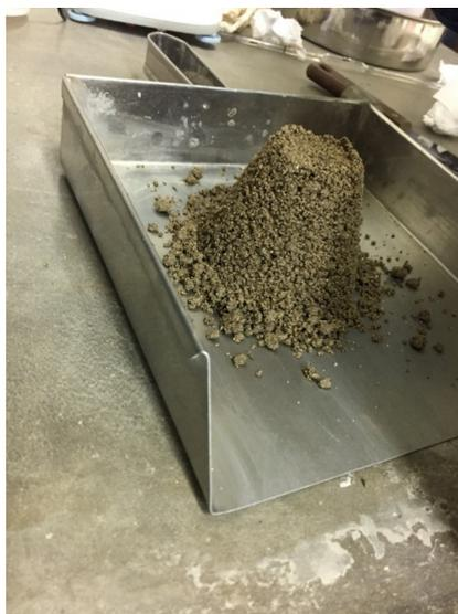
**Figura 42.** Agregado fino en estado saturado superficialmente seco [Fotografía de Jonatán Vera]. (Lima. 2018).
