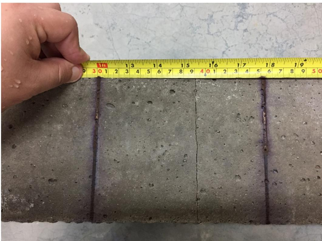
**Fotografía 22:** Medida de lados en la zona de rotura de la viga ensayada
