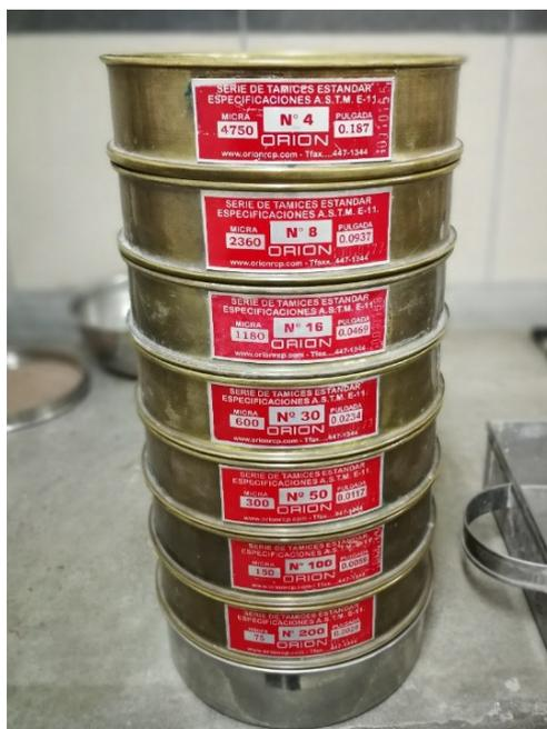
**Figura 6.** Tamices que se emplean en el análisis granulométrico del agregado fino [Fotografía de Gina Quispe]. (Lima. 2018).
