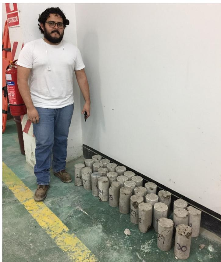
**Fotografía 18:** Probetas luego del ensayo de la resistencia a la compresión
