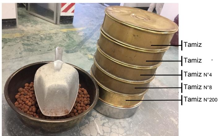
**Figura 31.** Tamices para tamizado de agregado grueso
