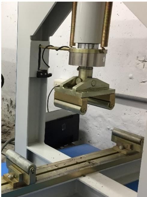
**Figura 25.** Aparatos de carga empleados en el ensayo para determinar la resistencia a la flexión para una viga de concreto
