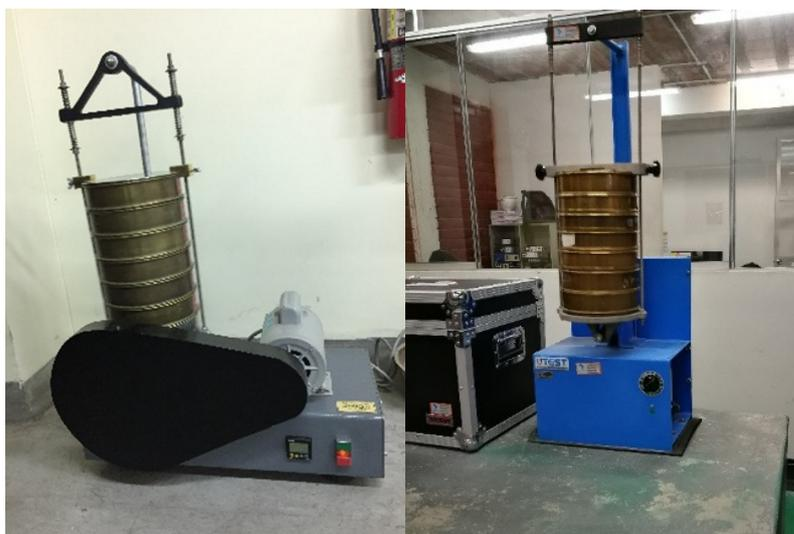
**Figura 7.** Agitadores mecánicos de tamices que se emplean en los análisis granulométricos [Fotografías de Jonatán Vera]. (Lima. 2018).
