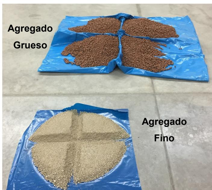
**Figura 26.** Muestreo de agregados
