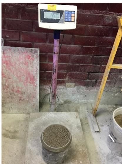
**Figura 18.** Determinación de la masa para obtener el peso unitario del concreto en estado fresco [Fotografía de Jonatán Vera]. (Lima. 2018).
