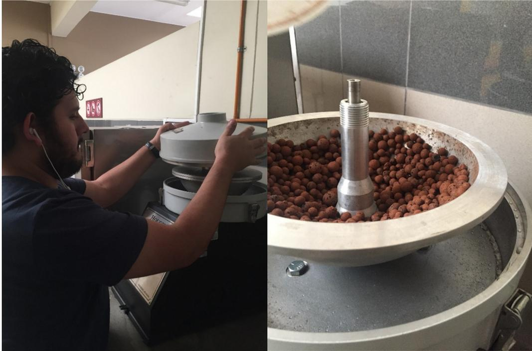
**Fotografía 5:** Centrifugado de agregado grueso liviano para ensayo de absorción [Fotografías de Gina Quispe]. (Lima. 2018).
