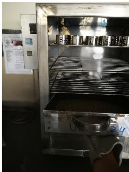
**Figura 40.** Secado del agregado grueso en el horno a  $110\text{ }^{\circ}\text{C}$
