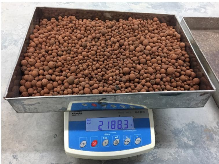
**Figura 27.** Muestra arcilla expandida para granulometría [Fotografía de Gina Quispe]. (Lima. 2018).
