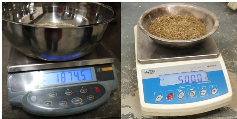
**Figura 5.** Balanzas debidamente calibradas. (a la izquierda imagen de la balanza empleada en el laboratorio de materiales de la Universidad de San Martín de Porres y a su derecha la balanza empleada en el laboratorio de diseño de la planta de Mixercon) [Fotografías de Jonatán Vera]. (Lima. 2018).
