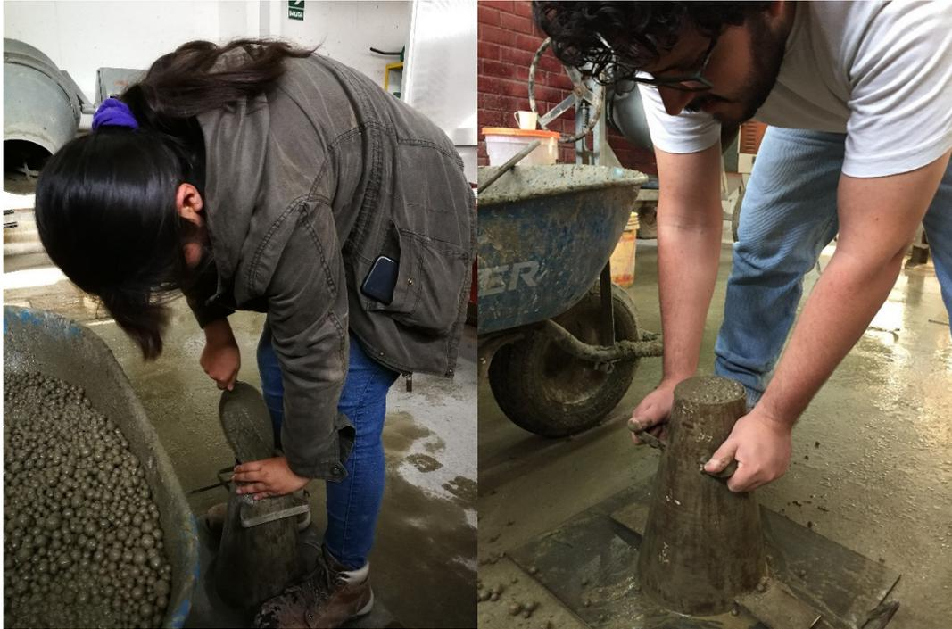
**Fotografía 11:** (Izquierda) Colocación de concreto (Derecha) Prueba de cono de Abrams
