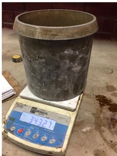
**Figura 15.** Medida empleada para el ensayo de peso unitario en estado fresco, volumen = 0.00702 m<sup>3</sup> (7.02 litros)
