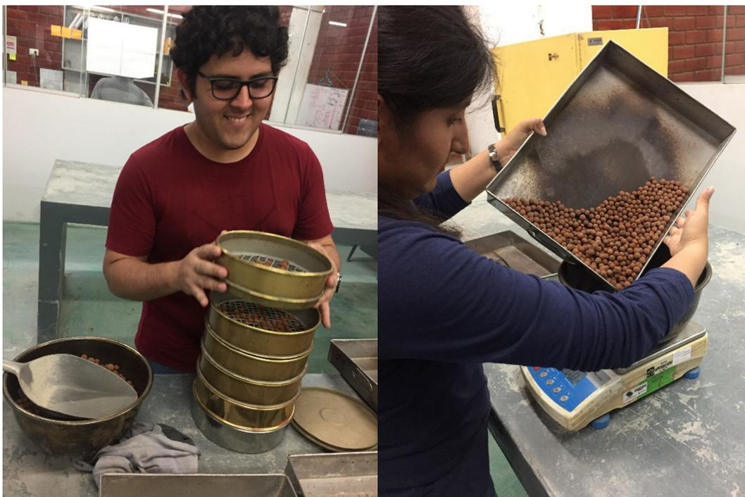
**Fotografía 3:** (Izquierda) Proceso de tamizado, (derecha) Pesado del agregado grueso liviano.
