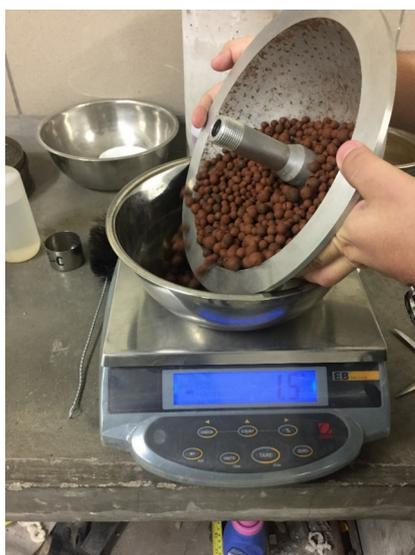
**Figura 39.** Medición de la masa del agregado grueso liviano luego de ser sacado de la centrifuga (20 minutos a 500 rpm) [Fotografía de Gina Quispe]. (Lima. 2018).
