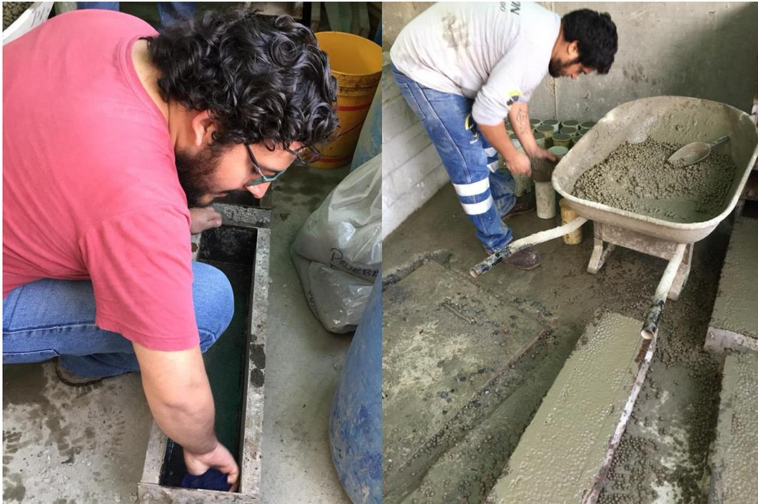
**Fotografía 13:** Preparación de molde para viga y colocación de concreto en probetas [Fotografías de Gina Quispe]. (Lima. 2018).
