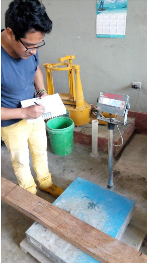
Foto N° 9: Peso propio de la viga y colocado de medidor de desplazamiento Central (deformación).
