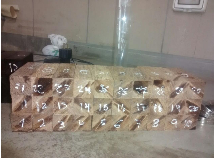
Foto N° 01: 30 Probetas de Dimensiones 3x3x10 Cm para el ensayo de contenido de humedad.
