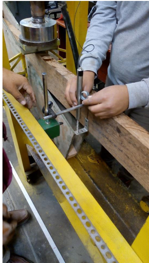
Foto N° 9: Peso propio de la viga y colocado de medidor de desplazamiento Central (deformación).
