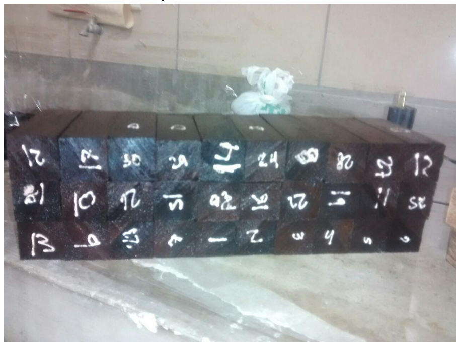
Foto N° 02: 30 Probetas de Dimensiones 3x3x10 Cm para el ensayo de densidad básica.
