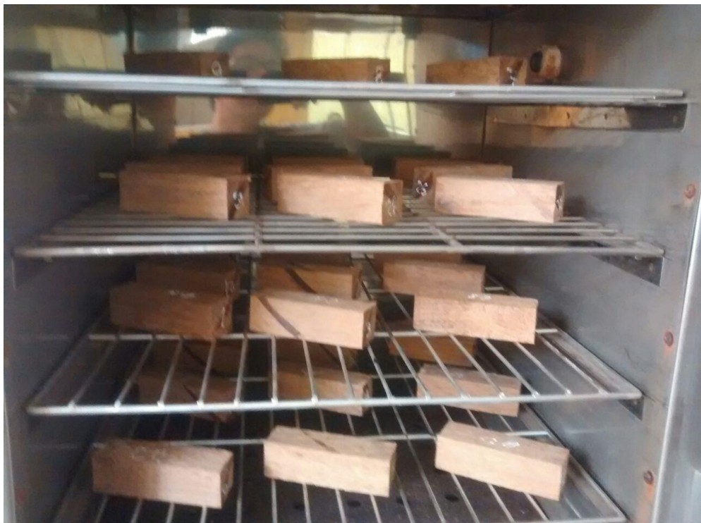
Foto N° 04: 30 Probetas extraídas de la estufa, para determinar el contenido de humedad
