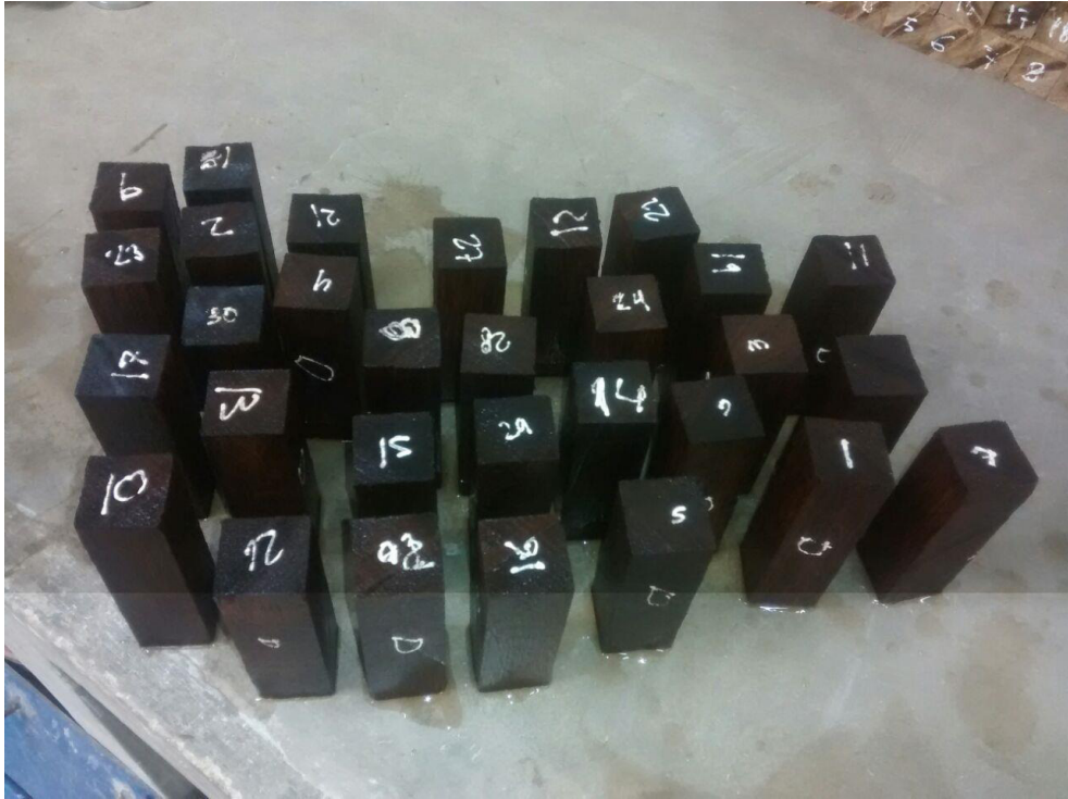
Foto N° 03: 30 Probetas para hallar el volumen saturado de la densidad básica.
