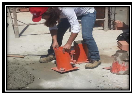
MUESTRA USADA PARA PRUEBA DE ASENTAMIENTO CON CONO DE ABRAMS Y ELABORACIÓN DE PROBETAS DE CONCRETO
