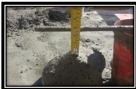
MUESTRA USADA PARA PRUEBA DE ASENTAMIENTO CON CONO DE ABRAMS Y ELABORACIÓN DE PROBETAS DE CONCRETO
