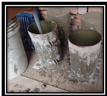
MUESTRA USADA PARA PRUEBA DE ASENTAMIENTO CON CONO DE ABRAMS Y ELABORACIÓN DE PROBETAS DE CONCRETO
