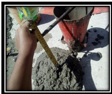
MUESTRA USADA PARA PRUEBA DE ASENTAMIENTO CON CONO DE ABRAMS Y ELABORACIÓN DE PROBETAS DE CONCRETO
