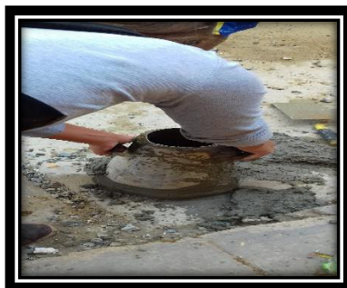
MUESTRA USADA PARA PRUEBA DE ASENTAMIENTO CON CONO DE ABRAMS Y ELABORACIÓN DE PROBETAS DE CONCRETO
