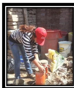
MUESTRA USADA PARA PRUEBA DE ASENTAMIENTO CON CONO DE ABRAMS Y ELABORACIÓN DE PROBETAS DE CONCRETO
