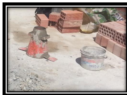
MUESTRA USADA PARA PRUEBA DE ASENTAMIENTO CON CONO DE ABRAMS Y ELABORACIÓN DE PROBETAS DE CONCRETO
