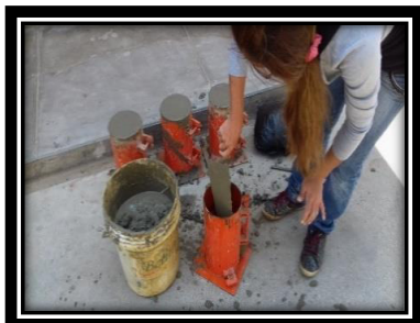
MUESTRA USADA PARA PRUEBA DE ASENTAMIENTO CON CONO DE ABRAMS Y ELABORACIÓN DE PROBETAS DE CONCRETO
