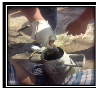
MUESTRA USADA PARA PRUEBA DE ASENTAMIENTO CON CONO DE ABRAMS Y ELABORACIÓN DE PROBETAS DE CONCRETO
