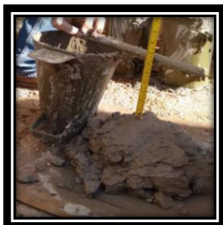
MUESTRA USADA PARA PRUEBA DE ASENTAMIENTO CON CONO DE ABRAMS Y ELABORACIÓN DE PROBETAS DE CONCRETO
