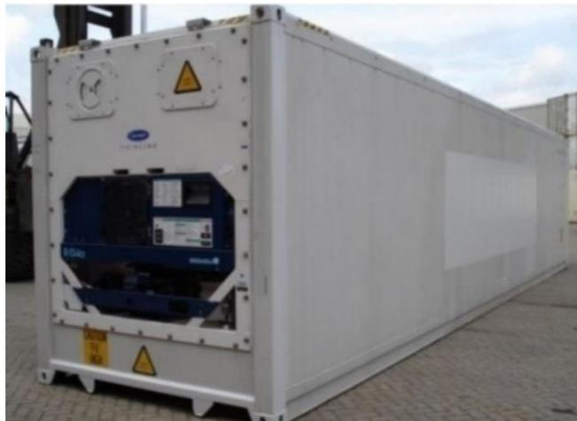
**Figura 10. Contenedor Refrigerado o Reefer Container**
