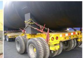
Aplicación de la cadena y ratchet para trincar la carga especial
