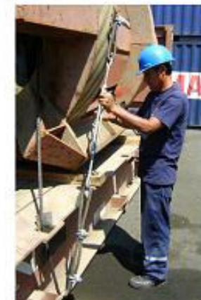
Ajuste del "Tensor" en la trínca de una maquinaria
