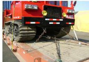
Aplicación de cadenas, cables, tensores para trincar el tractor Druga
