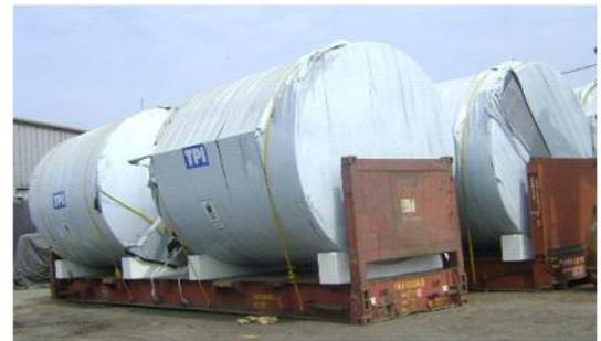
Trincando de cargas especiales con fajas de polipropileno
