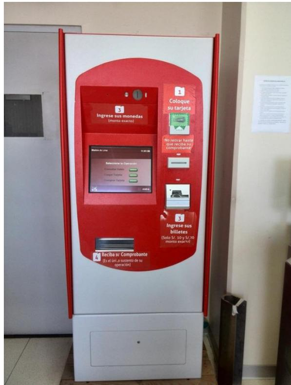
**Figura 1: TVM o Máquina automática de recarga.**
