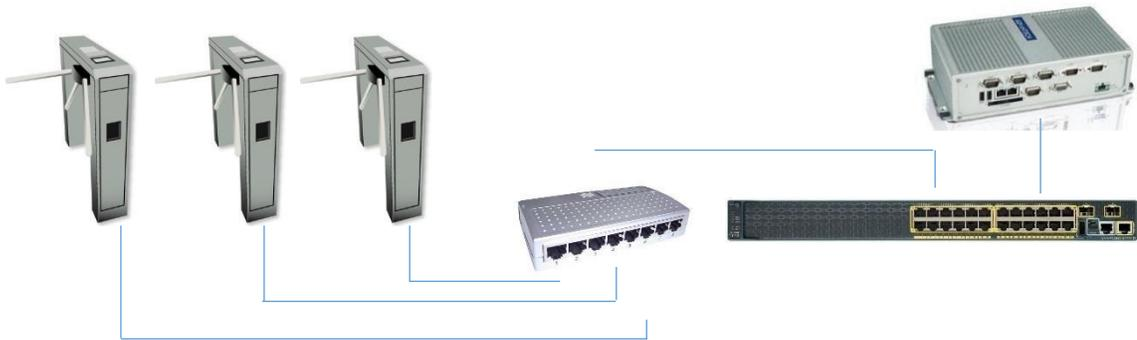
**Figura 63: Ejemplo de conexión con hub**
