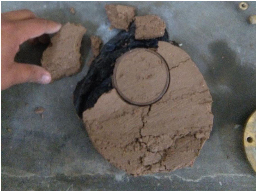
[Fotografía de Alejandro Yataco]. (Lab. de Mecánica de suelos de la USMP. 2017). Tallado de muestra arcillosa curada a 7 días, Lima, La molina.
