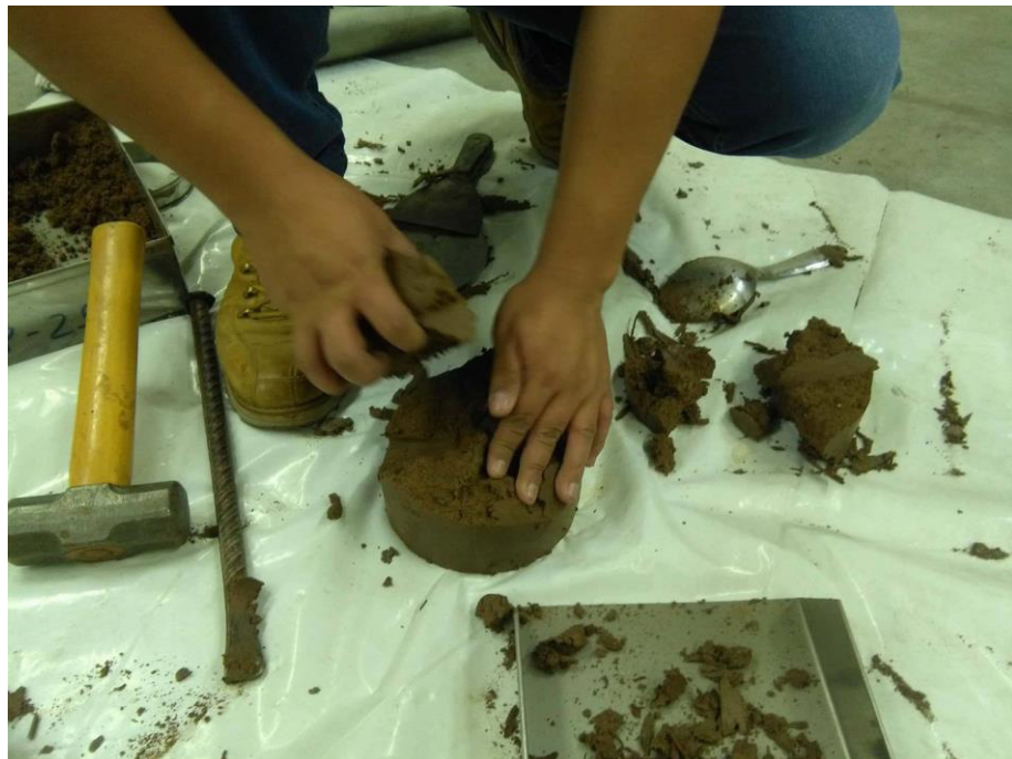
[Fotografía de Lux Mamani]. (Lab. de Mecánica de suelos de la USMP. 2017). Toma de espécimen, Lima, La molina.
