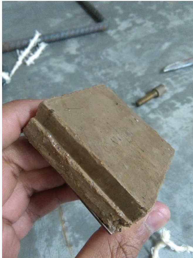
[Fotografía de Alejandro Yataco]. (Lab. de Mecánica de suelos de la USMP. 2017). Muestra resultante al finalizar el ensayo de Corte, Lima, La molina.
