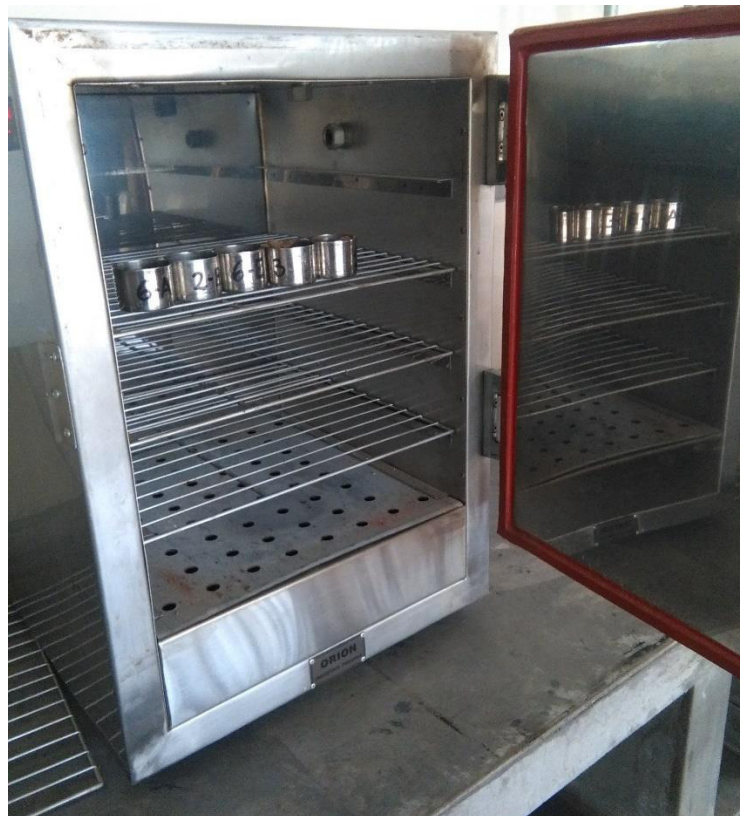
[Fotografía de Alejandro Yataco]. (Lab. de Mecánica de suelos de la USMP. 2017). Muestras puestas al horno, Lima, La molina.
