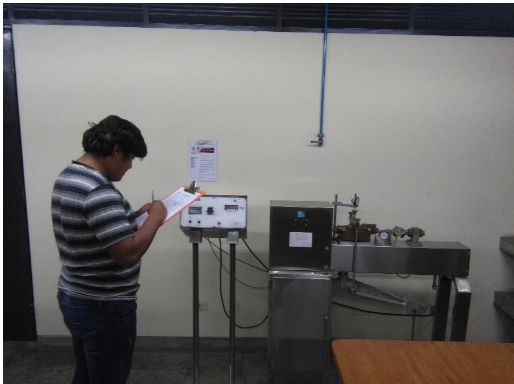
Figura 3.16. Toma de lectura del desplazamiento horizontal para el ensayo de Corte Directo
