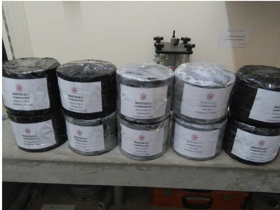
[Fotografía de Alejandro Yataco]. (Lab. de Mecánica de suelos de la USMP. 2017). Muestras curadas a 7 y 14 días, Lima, La molina.
