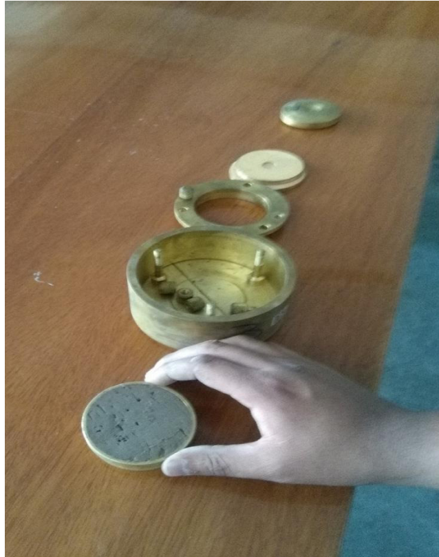
[Fotografía de Lux Mamani]. (Lab. de Mecánica de suelos de la USMP. 2017). Armado del molde para el ensayo de Consolidación unidimensional, Lima, La Molina.
