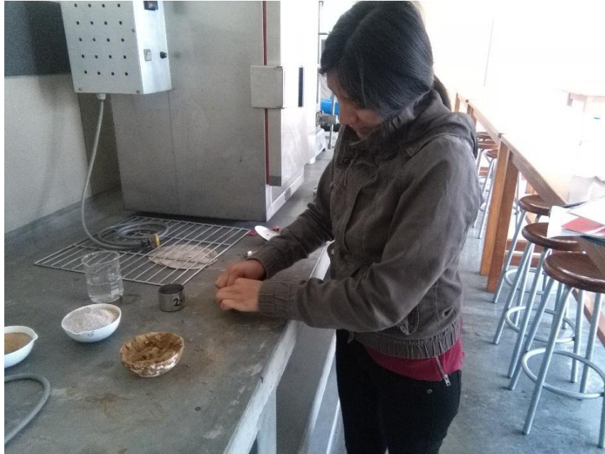
Figura 3.4. Preparación de muestra para el ensayo de Límite Plástico.
