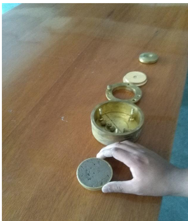
Figura 3.10. Armado del Molde para consolidación
