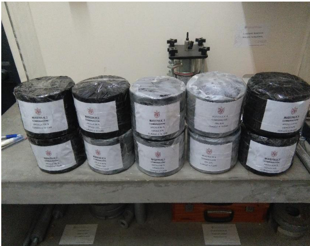
Figura 3.15. Curado de muestras a 7 y 14 días entre arcilla – ceniza de fondo para el ensayo de Corte Directo
