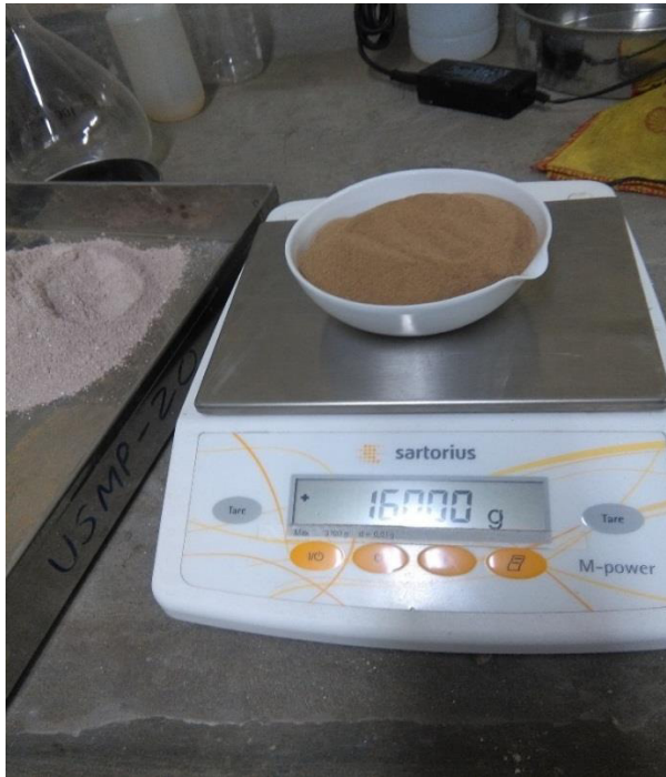
[Fotografía de Lux Mamani]. (Lab. de Mecánica de suelos de la USMP. 2017). Muestra del peso de Arcilla que será sometida al ensayo, Lima, La molina.
