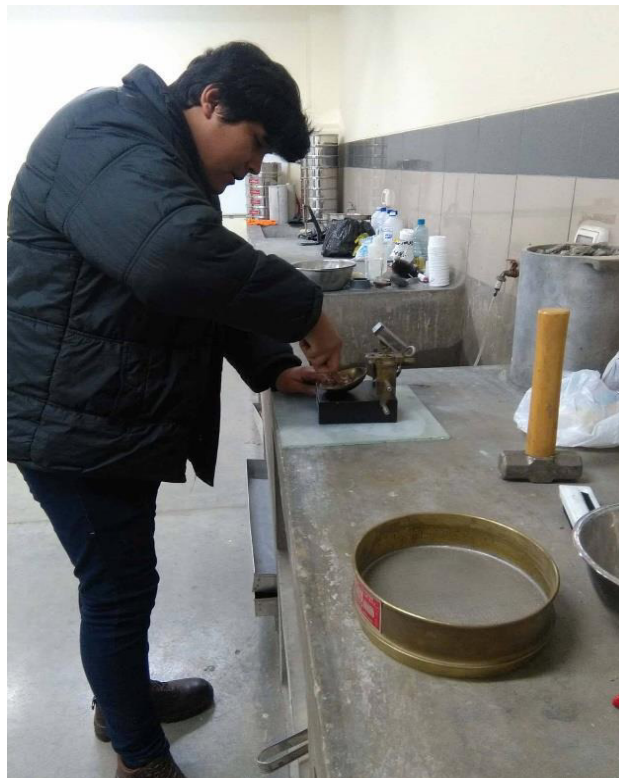
Figura 3.3. Ensayo de Límite Líquido con la cuchara de Casagrande.
