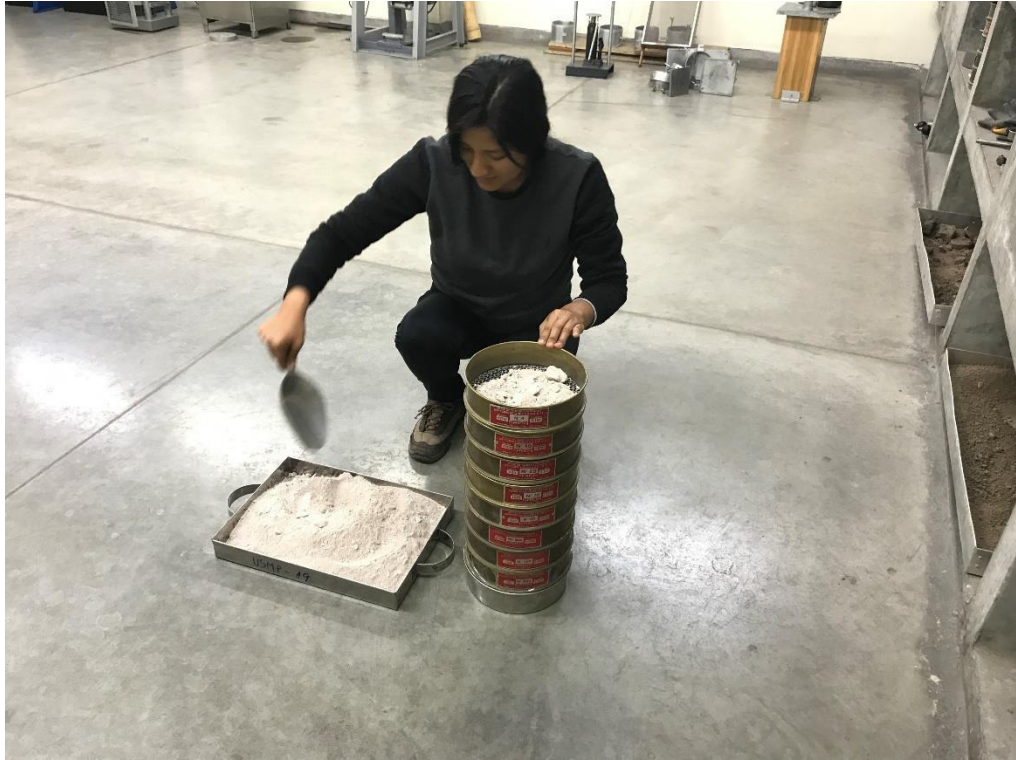
[Fotografía de Alejandro Yataco]. (Lab. de Mecánica de suelos de la USMP. 2017). Vista de la ceniza que pasó por los tamices, Lima, La molina.
