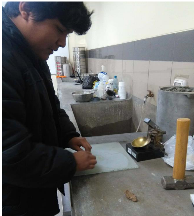
[Fotografía de Lux Mamani]. (Lab. de Mecánica de suelos de la USMP. 2017). Amasado de la mezcla arcillosa, Lima, La molina.
