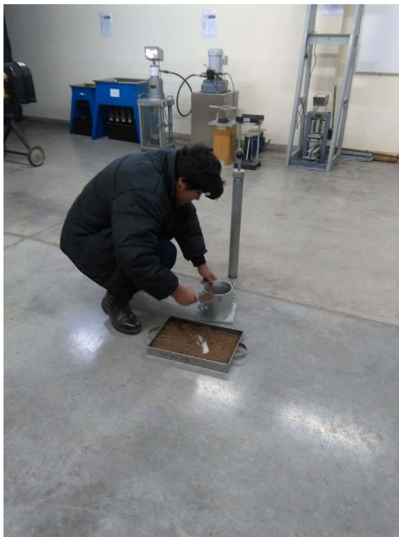
Figura 3.8. Compactación mediante 5 capas de suelo para el ensayo de Próctor Modificado NTP 339.141
