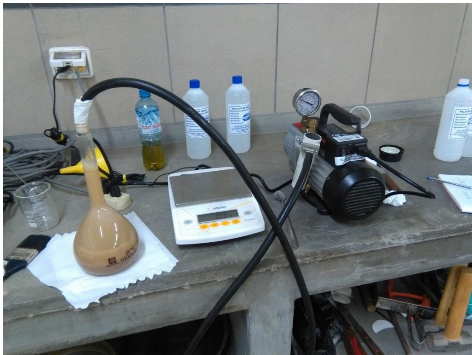
[Fotografía de Lux Mamani]. (Lab. de Mecánica de suelos de la USMP. 2017). Se retira el aire de la muestra + agua, Lima, La molina.
