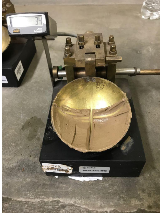
[Fotografía de Alejandro Yataco]. (Lab. de Mecánica de suelos de la USMP. 2017). Corte que se realizó con el ranurador, Lima, La molina.
