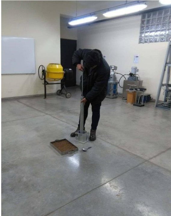
Figura 3.7. Compactación del suelo mediante el martillo manual para el ensayo de Próctor Modificado NTP 339.141.
