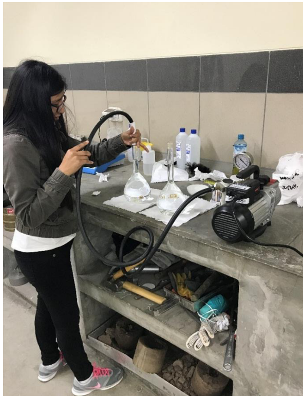
[Fotografía de Alejandro Yataco]. (Lab. de Mecánica de suelos de la USMP. 2017). Utilización de la Bomba de vacíos para la extracción de aire del agua, Lima, La molina.
