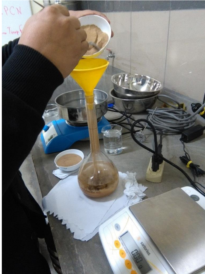
[Fotografía de Lux Mamani]. (Lab. de Mecánica de suelos de la USMP. 2017). Muestra ingresada al Picnómetro, Lima, La molina.
