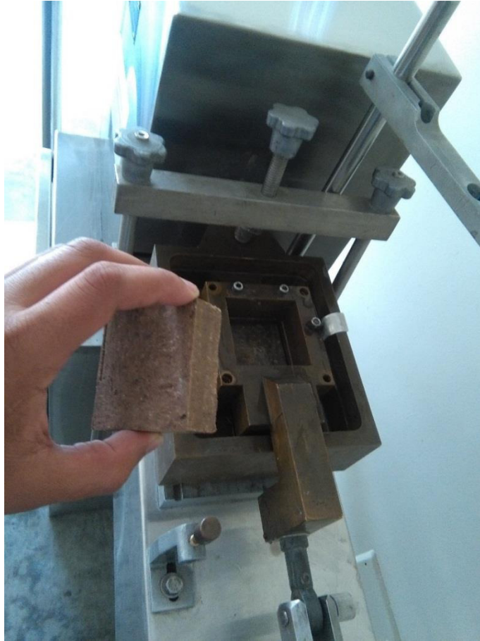
[Fotografía de Alejandro Yataco]. (Lab. de Mecánica de suelos de la USMP. 2017). Muestra que será colocada en la caja de corte, Lima, La molina.
