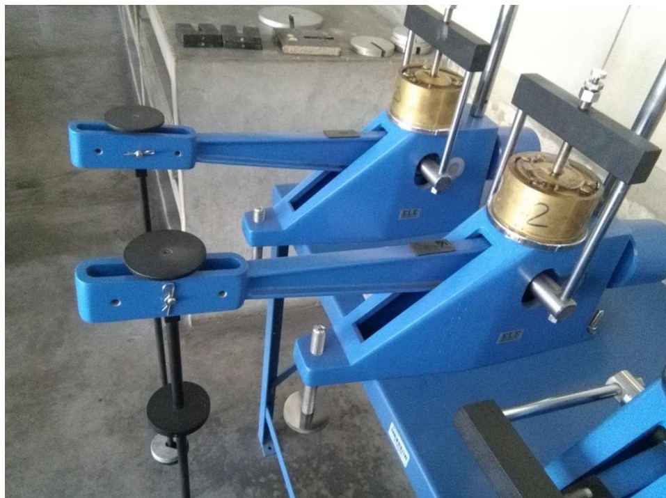
[Fotografía de Lux Mamani]. (Lab. de Mecánica de suelos de la USMP. 2017). Moldes de consolidación colocados en el consolidómetro, Lima, La Molina.
