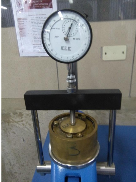
[Fotografía de Lux Mamani]. (Lab. de Mecánica de suelos de la USMP. 2017). Toma de muestra del Dial de deformación aplicado a la muestra, Lima, La molina.
