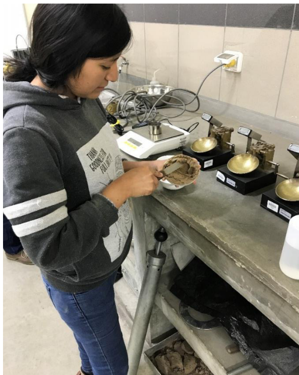
[Fotografía de Alejandro Yataco]. (Lab. de Mecánica de suelos de la USMP. 2017). Preparación de la mezcla con agua, Lima, La molina.
