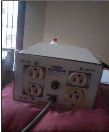
Figura 36. Estabilizador de Voltaje. Elaboración: el autor.
