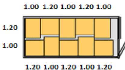
**Figura N° 16:** Cubicaje de la carga
