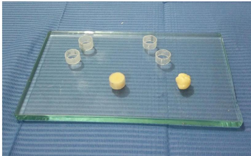
Moldes utilizados para la fabricación de las probetas.
