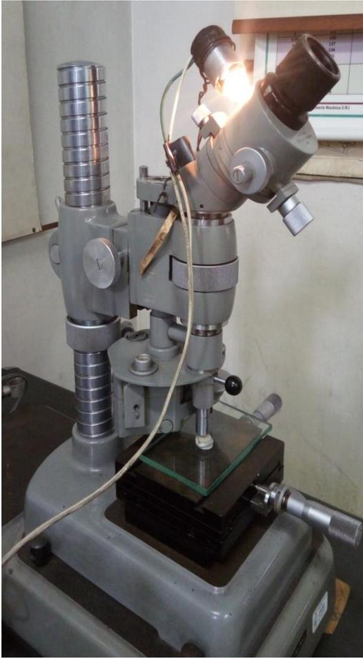
Durómetro Vickers utilizado en el estudio
