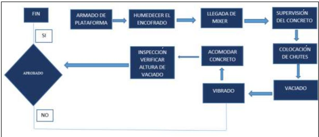
**Figura 12.** Diagrama de flujo vaciado de muro
