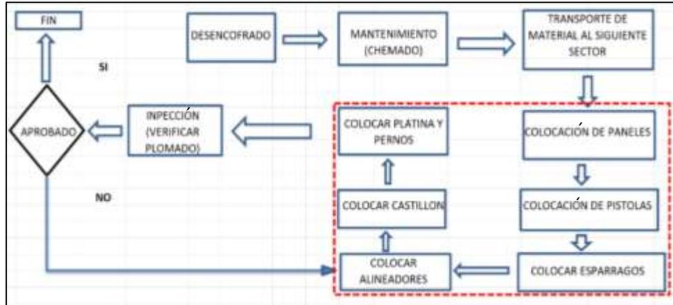
**Figura 8.** Diagrama de flujo de la partida de encofrado de muro
