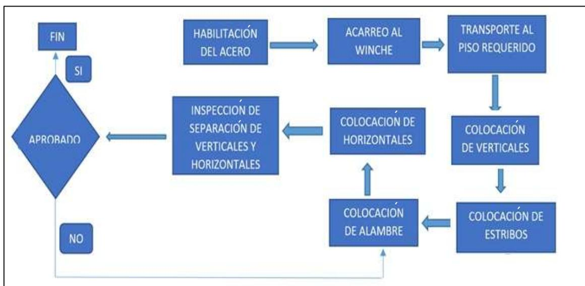
**Figura 20.** Diagrama de flujo de la partida de colocación de acero en placa
