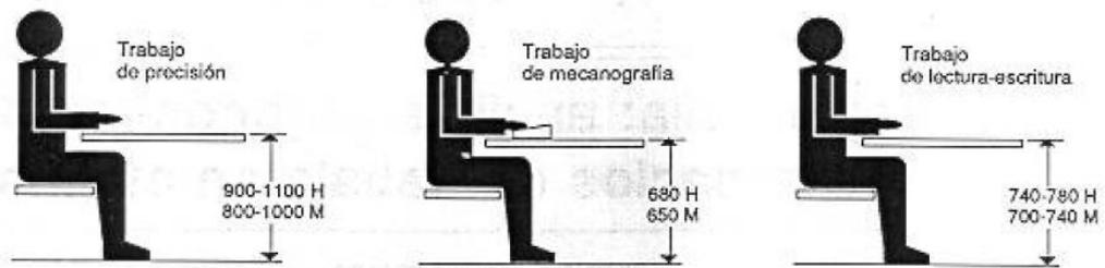
**Figura 77:** Altura del plano de trabajo para puestos de trabajo sentado
