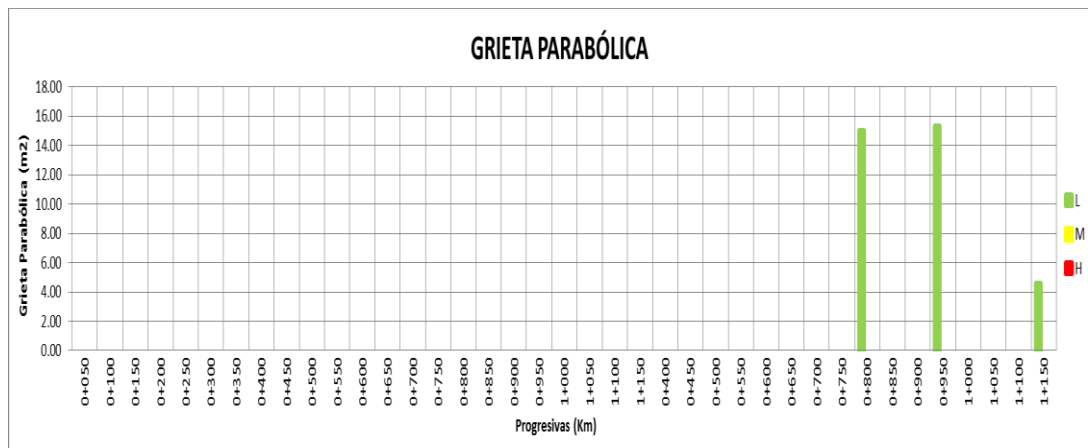
Figura 81: Distribución de deterioros (PR 0+000 – PR 1+150) – GRIETA PARABÓLICA
