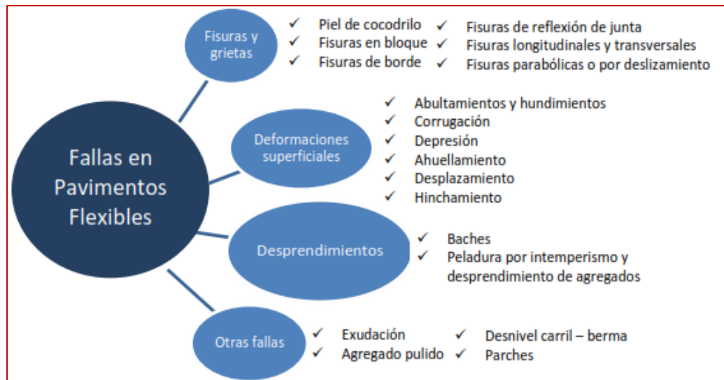
Figura 9: Fallas en los pavimentos flexibles establecidos por PCI.
