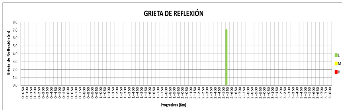
Figura 47: Distribución de deterioros (PR 0+000 – PR 3+800) – GRIETA DE REFLEXIÓN DE JUNTA
