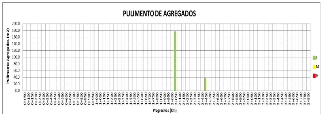
Figura 51: Distribución de deterioros (PR 0+000 – PR 3+800) – PULIMIENTO DE AGREGADOS
