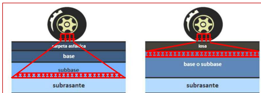
Figura 4: Comportamiento estructural de los pavimentos
