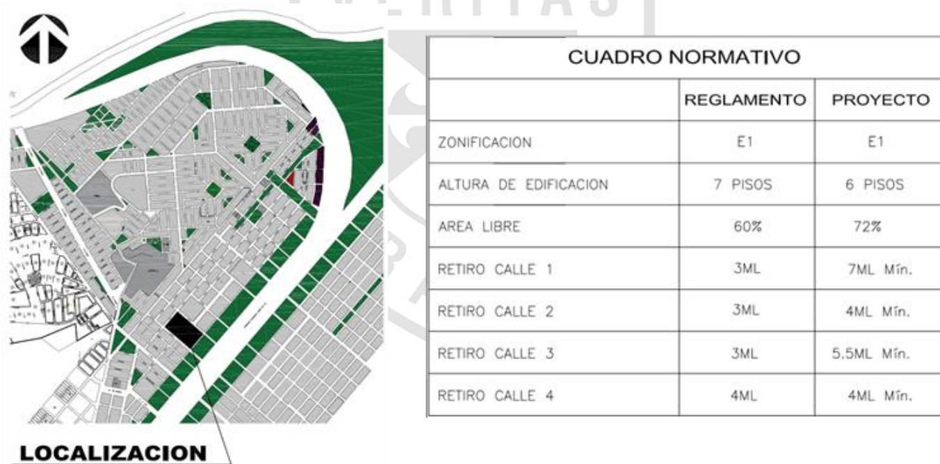
Figura N°55: Esquema de localización y cuadro normativo del terreno Fuente: Municipalidad de Ancón
