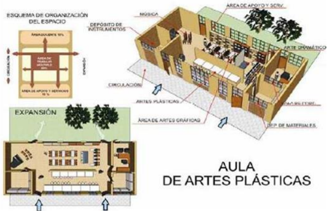
Figura N°14: Organización del espacio Aula de artes plásticas Fuente: Normas técnicas para el diseño de escuelas de inicial primaria y secundaria (MINEDU)
