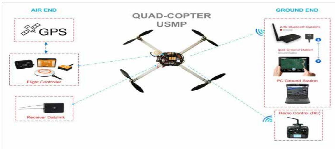
Figuras 6. Configuración General de Quad-rotor USMP
