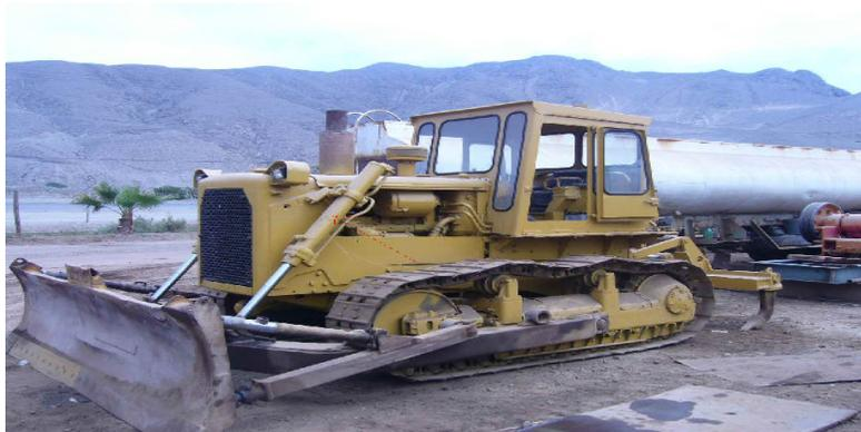
FOTO 5: UBICACIÓN DE CILINDRO DE INCLINACIÓN CAT 844 EN BULLDOZER
