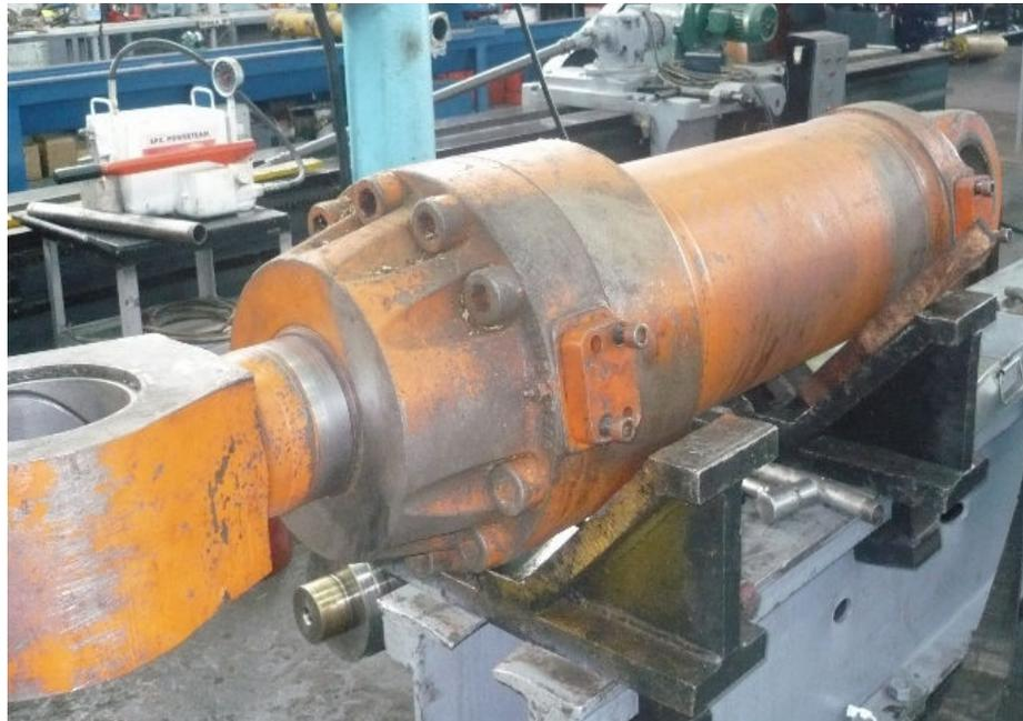
FOTO1: CILINDRO DUMP<sup>1</sup> EX 5500 (CILINDRO DE VACIADO DE EXCAVADORA EX 5500)
