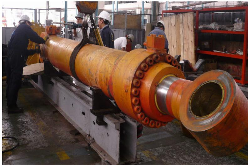
FOTO 2: CILINDRO BOOM<sup>2</sup> EX 5500 (CILINDRO DE AGUILÓN DE EXCAVADORA EX 5500)
