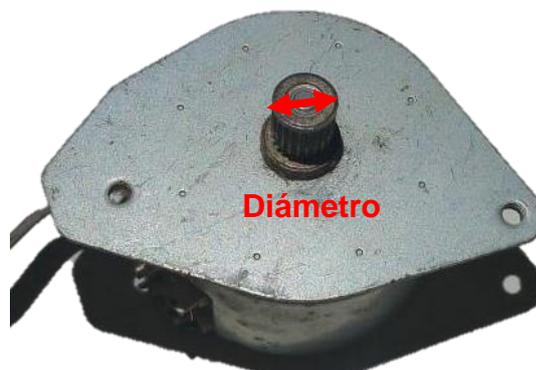
**Fig. 21 Motor de Paso**
