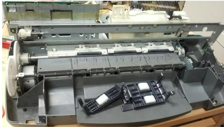
**Fig. 2.1 Chasis impresora EPSON C43**
