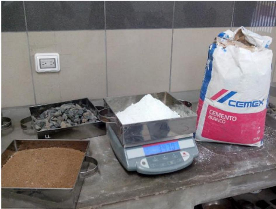
**Fotografía 3.** Dosificación para Diseño de Concreto con Cemento Blanco Tolteca
