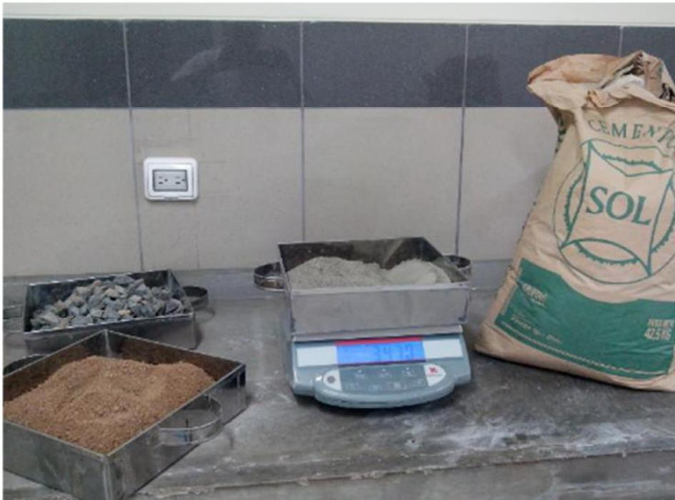
**Fotografía 4.** Dosificación para Diseño de Concreto con Cemento Gris Sol
