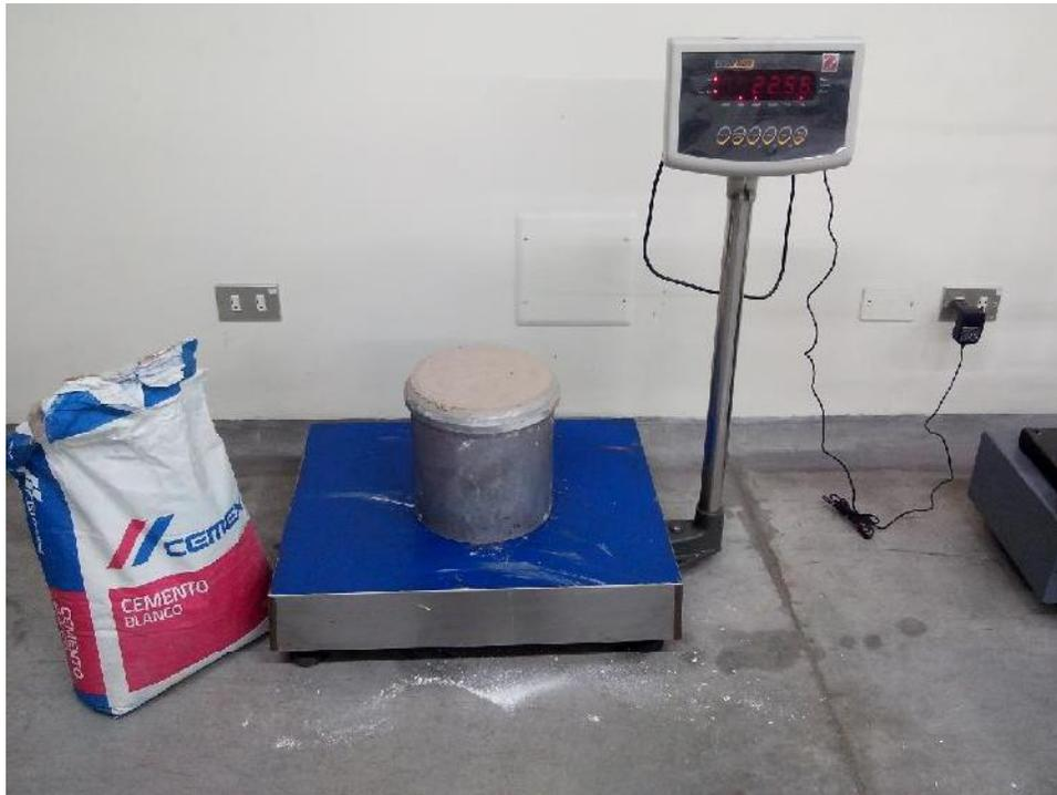
**Fotografía 9.** Ensayo de Peso Unitario y Contenido de Aire del concreto.
