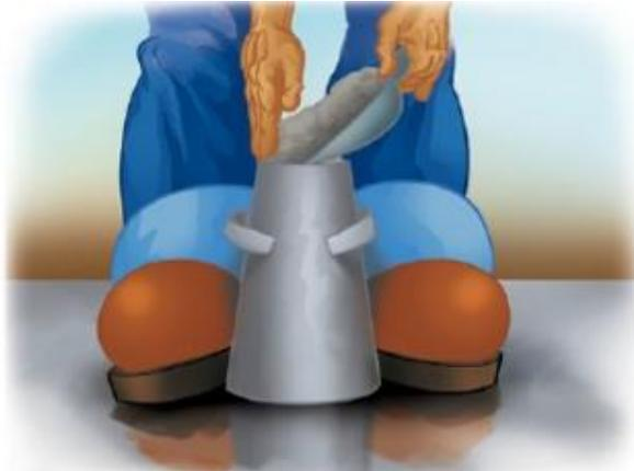
**Gráfico 8.** Primera capa para la determinación del asentamiento del concreto
