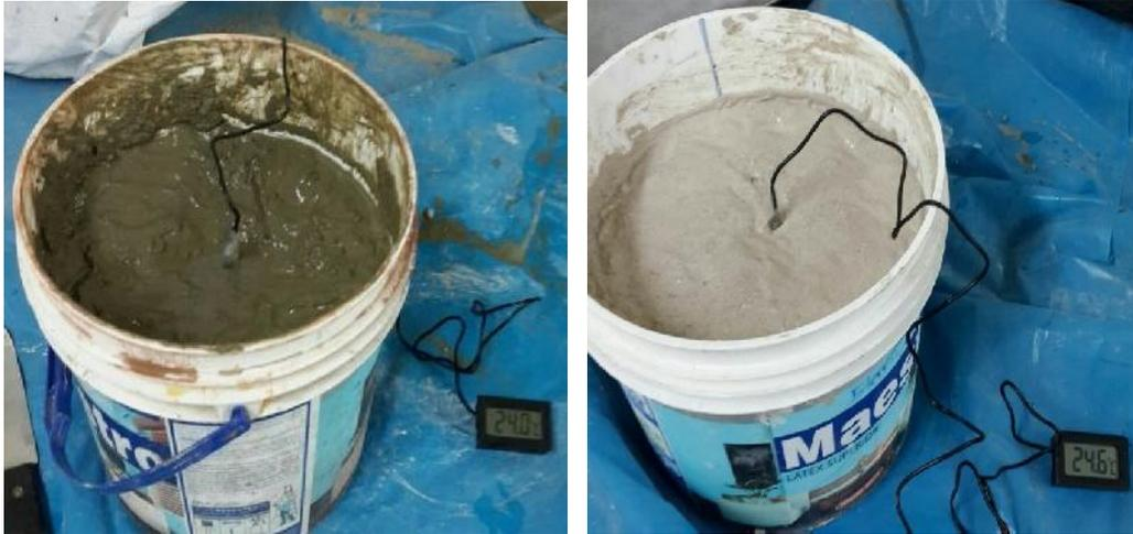
**Fotografía 11.** Ensayo de Temperatura del Concreto con Cemento Blanco Tolteca y Cemento Gris Sol.
