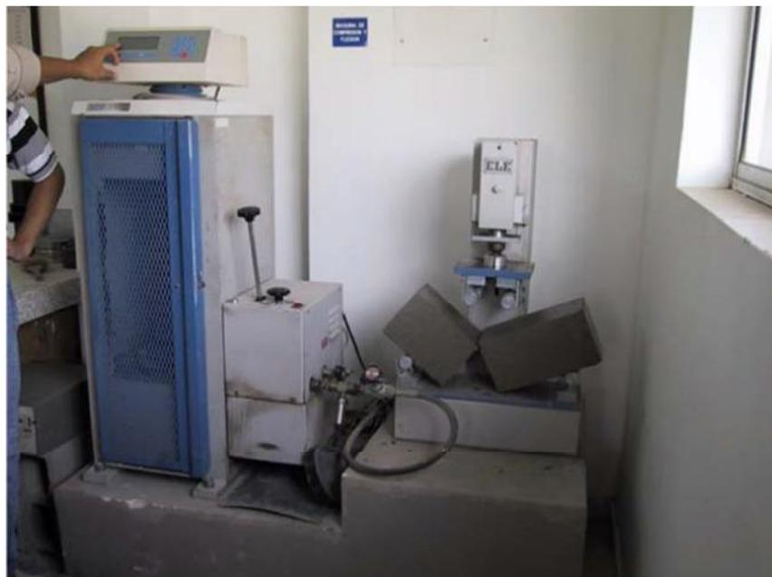
**Gráfico 12.** Ensayo de Resistencia a la flexión
