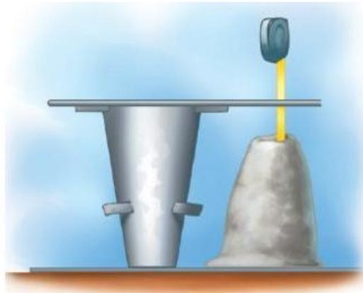
**Gráfico 10.** Medición del Slump para determinar el asentamiento del concreto
