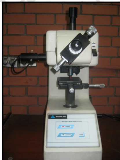
Figura N°9: Microdurómetro de Vickers.
