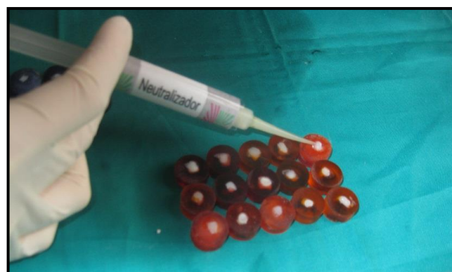
Figura N°22: Aplicación de neutralizador.
