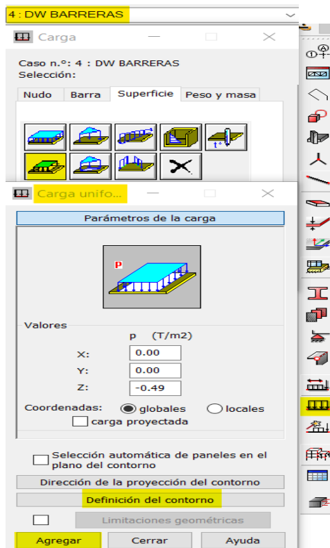
Figura 54. Definición de aplicación de carga de barreras.
