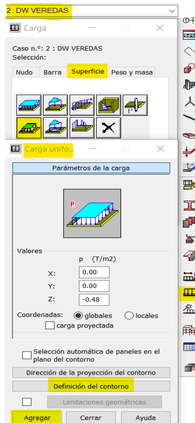
Figura 52. Definición de aplicación de carga de veredas.
