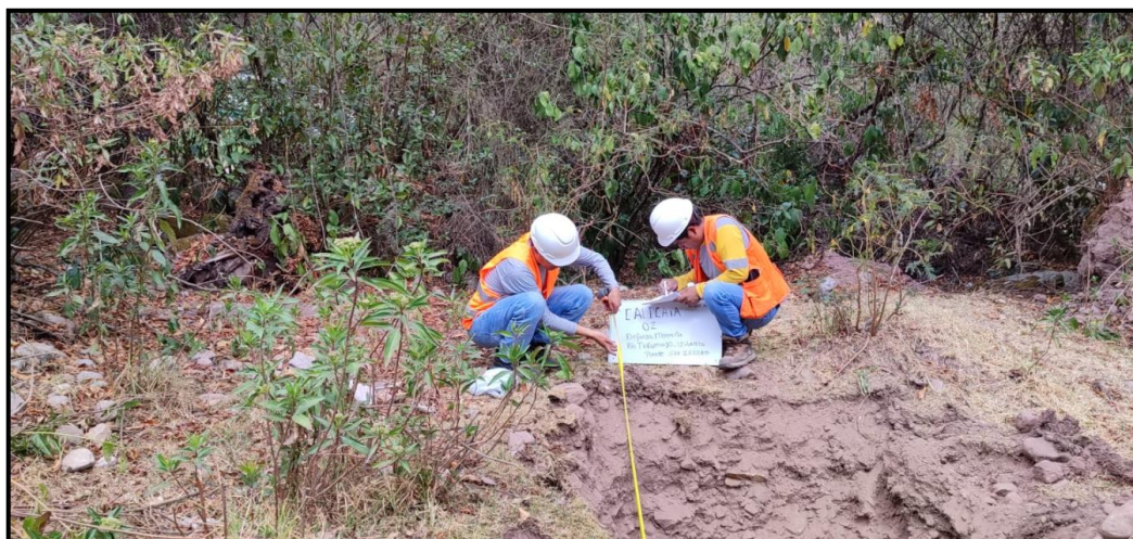
Toma de muestra de la calicata 06
