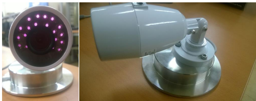
Figura 3.1: Cámara infrarroja con soporte metálico en la parte inferior.
