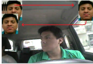
Figura 3.7: Correlación del template del rostro con la imagen de entrada, realizando barrido punto a punto.
